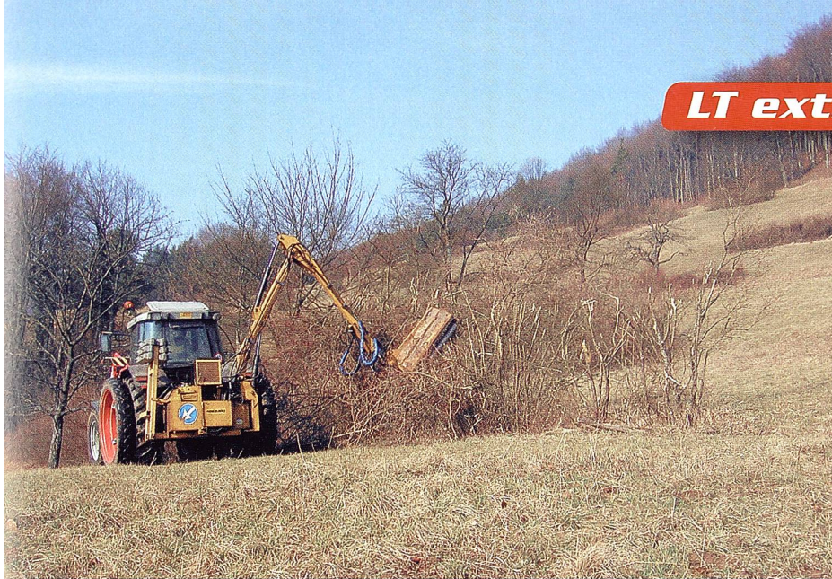
Die Heckenpflege mit Motorsäge und Durchforstungsschere ist sehr arbeitsaufwändig. Sie wird deshalb vermehrt mit Schlegelmulchern für die Böschungspflege durchgeführt. Das Abschlegeln von Niederhecken darf nur während der Vegetationsruhe ausgeführt werden. (Bild: Thomas Baumann, Naturama Aargau, Aarau)
