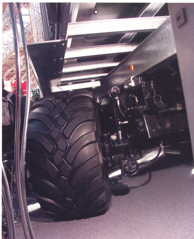
Neuer Fliegl-Abschiebewagen mit einem Chassis, das sich relativ zur Tridemachse vom Traktor aus verschieben lässt, um die Stützlast je nach Arbeitssituation einerseits und für die Strassenfahrt andererseits anzupassen.
