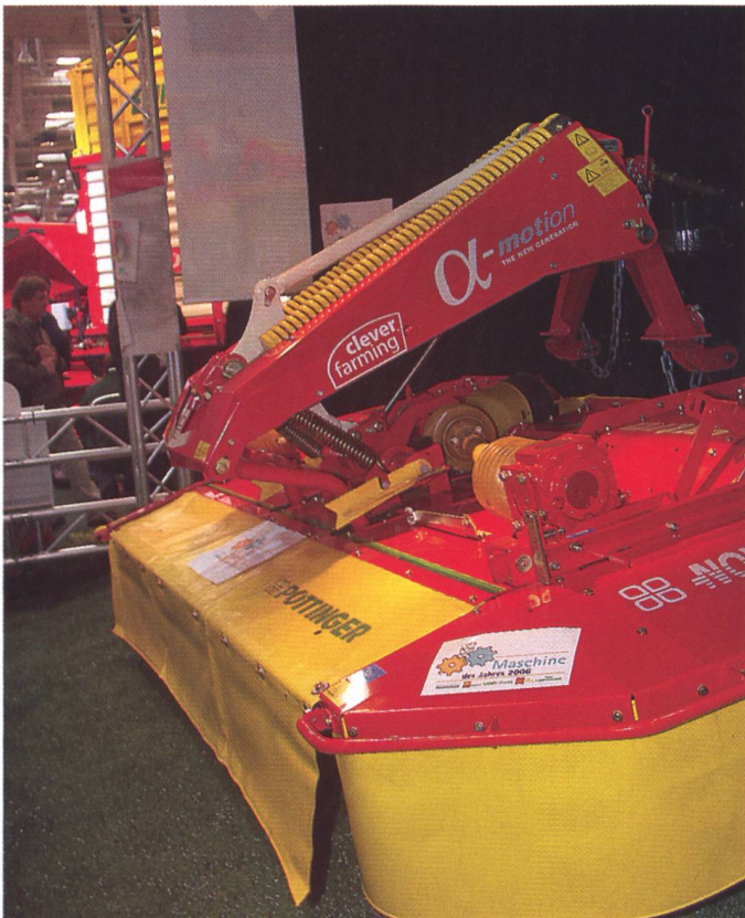
Neues Mähwerk von Pöttinger mit nochmals optimierter Technologie und Geometrie für die Anpassung des Mähwerks an Bodenunebenheiten im coupierten Gelände.
