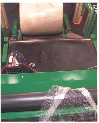
In Zusammenarbeit mit der Firma Orkel bringt die Baltensberger AG, Brütten ZH, für die Ballensiliertechnik demnächst statt einer Netzbindung eine Folienumwicklung auf den Markt. Diese ersetzt die luftdicht abschliessende Silierfolie nicht, erleichtert hingegen das Handling beim Ballenauflösen.
