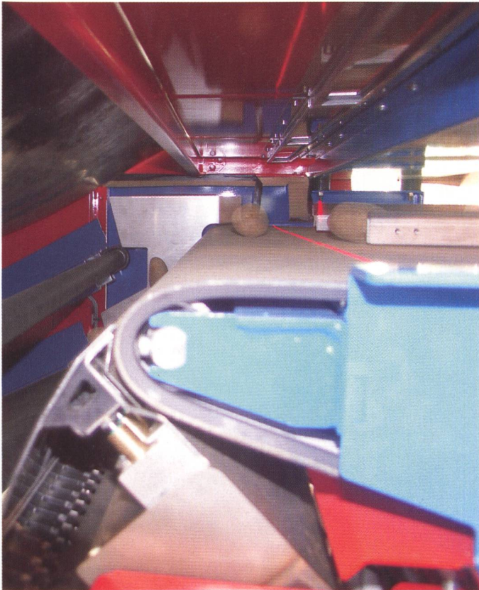
Samro: Nach dem Ausstieg aus der Herstellung von Kartoffelvollerntern noch absoluter Spezialist im Handling der Knollengewächse. Blick auf die fotometrische Ausmessung der Knollen an einer Infrarotlichtschranke als Mass für die Sortierungszuteilung über pneumatisch betätigte Impulsgeber.
