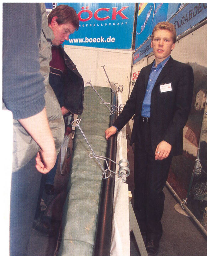
Die Firma Böck in Trostberg (D) zeigt ein einfaches Spannsystem anstelle von Sandsäcken für das sichere Abdichten am Fahrsilo. Das System kann auch nachgerüstet werden.
