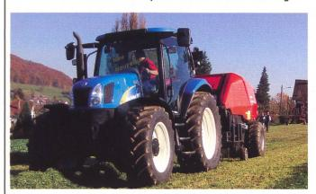
Zur Bucher-Landtechnik-Herbstmesse in Niederwenigen sind gegen 7000 Interessierte gekommen. Eine unter vielen bemerkenswerten Neuheiten war dabei die Ausrüstung der New Holland TSA-Serie mit einer Fast-Steer-TM-Funktion. Damit kann man durch Niederdrücken des Innenrings im Lenkrad mit einer kurzen Drehbewegung die Radstellung an der Vorderachse von einem Anschlag zum andern wählen.
