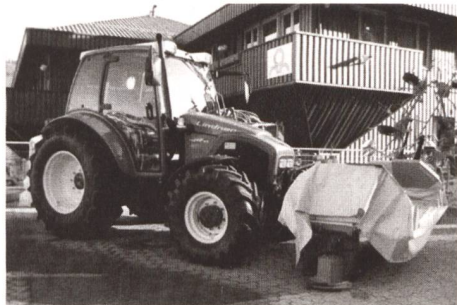
Lindner Geotrac 73 A alpin mit achsgeführter Fronthydraulik
