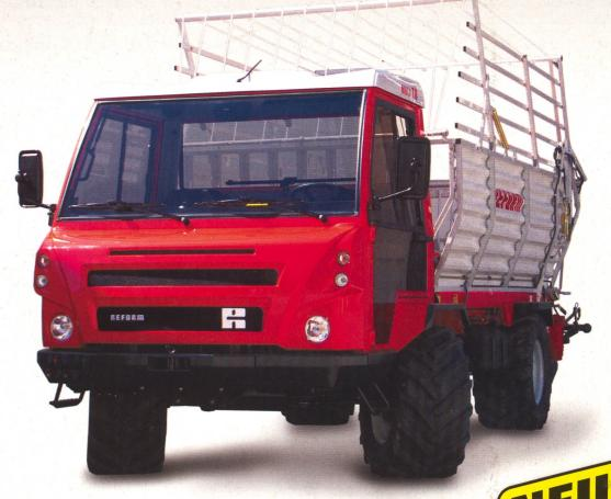
Jetzt mit **HCS** *High Comfort Suspension* – Einzelradfederung mit Niveauregulierung.
