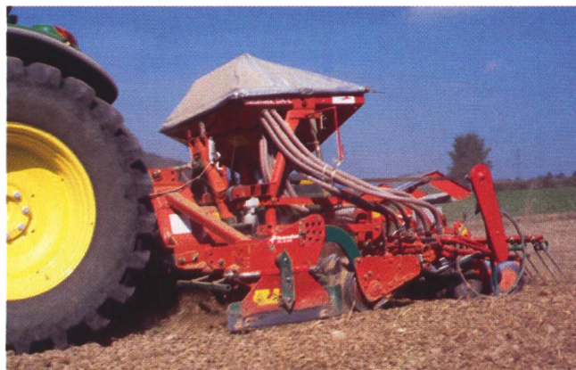
Abb. 2: Die Saatbettbereitung erfolgte bei allen Verfahren mit einer Kreiselegge. Für die Getreidesaat auf 25cm Reihenweite bei BIO verschloss ein Einsatz im Verteilerkopf der pneumatischen Sämaschine jede zweite Öffnung.
