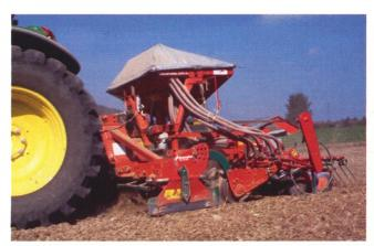
Abb. 2: Die Saatbettbereitung erfolgte bei allen Verfahren mit einer Kreiselegge. Für die Getreidesaat auf 25 cm Reihenweite bei BIO verschloss ein Einsatz im Verteilerkopf der pneumatischen Sämaschine jede zweite Öffnung.
