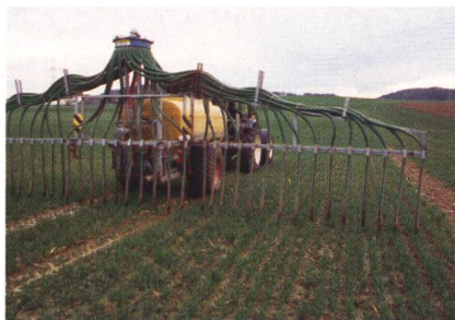
Abb. 3: Die Gülleausbringung (links) erfolgte mit einem Schleppschauchverteiler, während ein pneumatischer Streuer den Mineraldünger streute (rechts).
