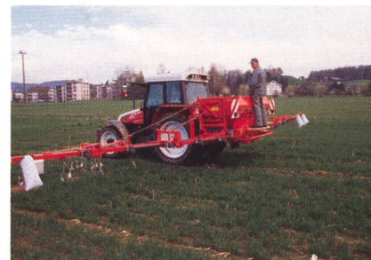
Abb. 3: Die Gülleausbringung (links) erfolgte mit einem Schleppschauchverteiler, während ein pneumatischer Streuer den Mineraldünger streute (rechts).
