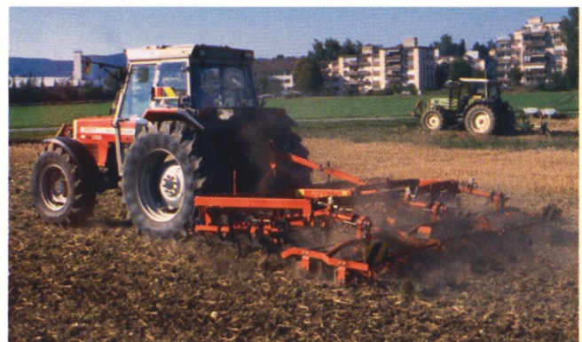
Abb. 10: Moderne, tiefengeführte Kurzscheibeneggen eignen sich bestens für die Durchführung einer Unkrautkur. Bei sauberer Strohräumung nach Getreide verrichtet aber auch die altbekannte Federzinkenegge (rechts) gute Arbeit.
