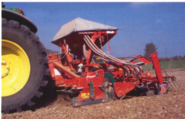
Abb. 2: Die Saattbettbereitung erfolgte bei allen Verfahren mit einer Kreiselegge. Für die Getreidesaat auf 25cm Reihenweite bei BIO verschloss ein Einsatz im Verteilerkopf der pneumatischen Sämaschine jede zweite Öffnung.
