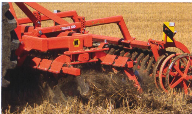
Abb. 10: Moderne, tiefengeführte Kurzscheibeneggen eignen sich bestens für die Durchführung einer Unkrautkur. Bei sauberer Strohräumung nach Getreide verrichtet aber auch die altbekannte Federzinkenegge (rechts) gute Arbeit.
