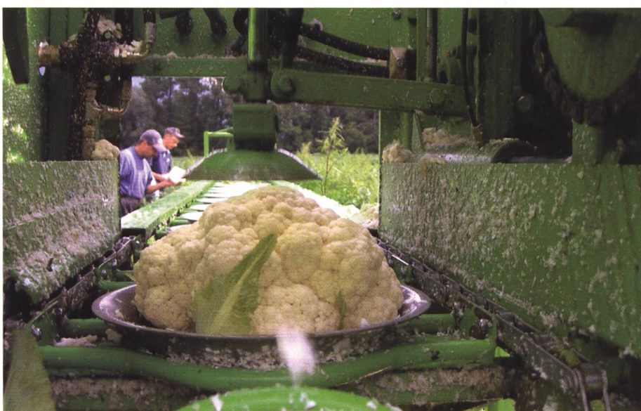
Innenleben der Maschine aus Belgien: Im nächsten Moment drückt die Glocke den Kohl nach unten, und ein Bohrer fräst den Stiel heraus. Via Förderband gelangen die losgetrennten Röslein in die Paloxen und charginweise in die Weiterverarbeitung mit Blanchieren, Frosten, Abpacken und Tiefkühlen auf -18°C. (Bild: Beni Dürr)
