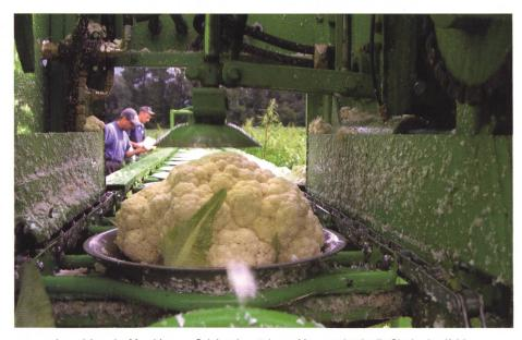
Innenleben der Maschine aus Belgien: Im nächsten Moment drückt die Glocke den Kohl nach unten, und ein Bohrer fräst den Stiel heraus. Via Förderband gelangen die losgetrennten Röslein in die Paloxen und chargenweise in die Weiterverarbeitung mit Blanchieren, Frosten, Abpacken und Tiefkühlen auf –18°C. (Bild: Beni Dürr)
