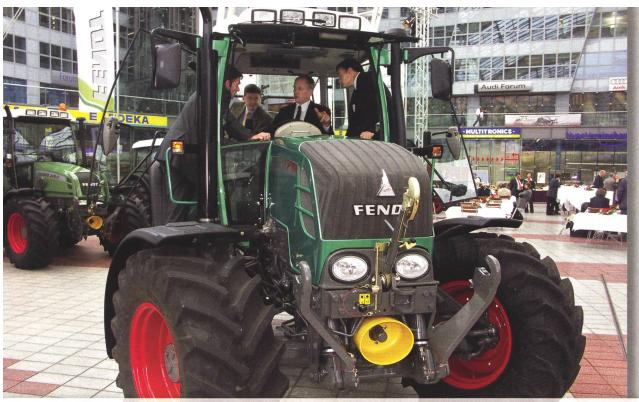
Neu: Fendt 312, ausgerüstet mit einem stufenlosen Vario-Getriebe. Der Traktor entwickelt bei einem Eigengewicht von 4390 kg 125 PS Leistung.
