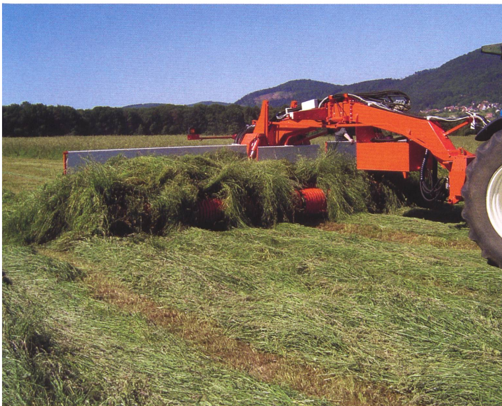
Bandschwader KUHN fördert das Futter schonend gegen die Mitte oder nach links und rechts (Werksbild).
