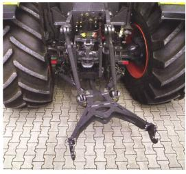
Claas Xerion mit schwenkbarer Heckhydraulik für den Ausgleich bei Hundeganglenkung (Werksbild).
