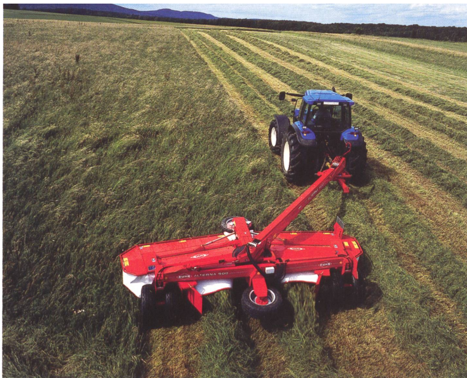
Das gezogene Mähwerk Alterna 500 mit einer Mähbreite von 5 Metern kann links oder rechts laufen.
