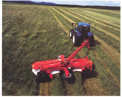
Das gezogene Mähwerk Alterna 500 mit einer Mähbreite von 5 Metern kann links oder rechts laufen.
