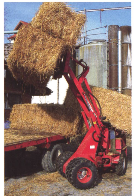
Ohne Fahrerschutz wird der Fahrer von herunterfallenden Strohballen eingeklemmt (Unfall nachgestellt, Bild: BUL).
