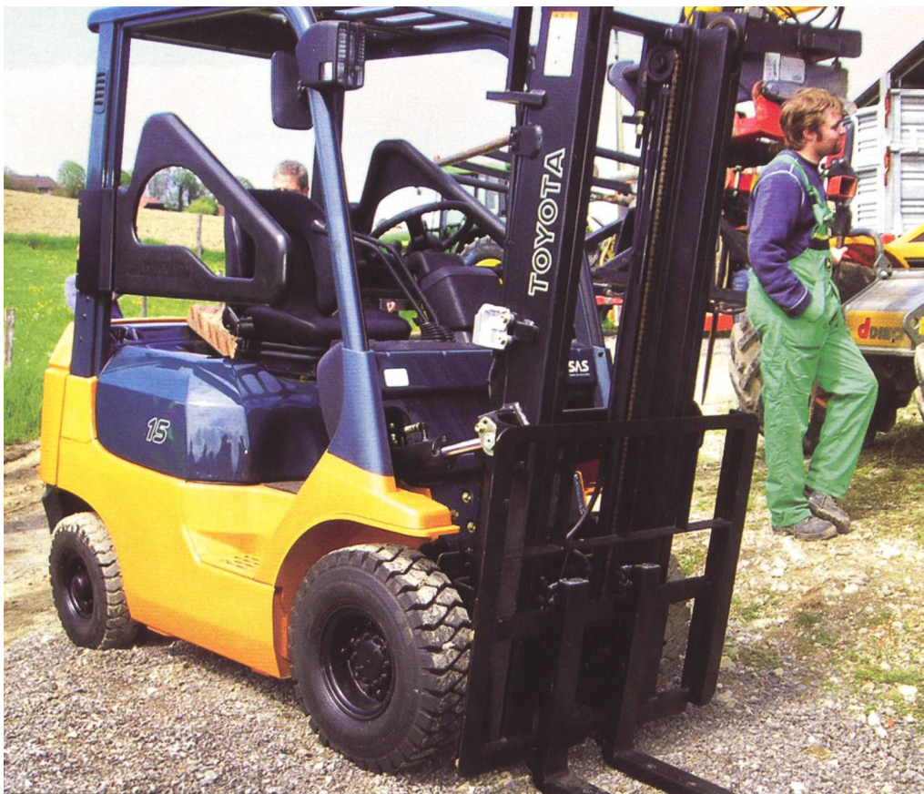
Rückhaltesystem mit seitlichen Bügeln an einem Hoflader (Bild: Monique Perrottet)
