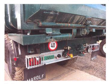
Marolf baut sein Wechselsystem auf einem 3,3 Tonnen schweren Chassis mit luftgefederter Tandemachse und Luftdruckbremsen auf. Mittels Luftdruck werden die Wechselaufbauten auch angehoben und auf die mitgeführten und nach unten klappbaren Stützen abgestützt. Verfügbar sind Aufbaumöglichkeiten für Ballentransport, Mulden für den Transport von Kies- und Aushubmaterial mit Kippmöglichkeiten auf drei Seiten bis zum Transport von Norm-Containern für LKWs.
