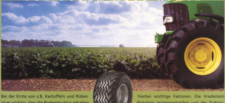
Bei der Ernte von z.B. Kartoffeln und Rüben ist es wichtig, dass die Bodenstruktur erhalten bleibt. Die hohe Tragfähigkeit, die große Kontaktfläche und die minimale Spurbildung sind
