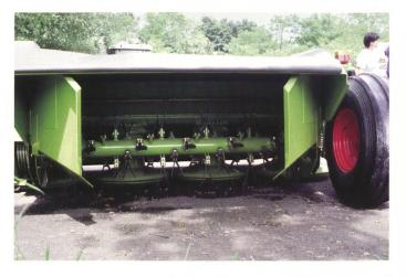
Gezogener Trommelmäher mit integriertem Aufbereiter mit pendelnden Stahlschlägeln.
