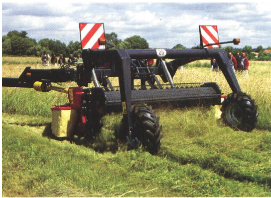
Gezogenes Mähwerk Vicon HPC mit integriertem Bürstenaufbereiter und Breitstreuwalze.
