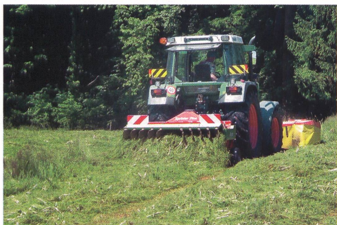
Gezogener Aufbereiter Sprinter Plus von GVS-Agrar mit integrierter Bürstenwalze als Intensivaufbereiter.
