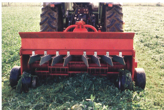
Kurmman K 618 TWIN: Das Breitstreu des intensiv aufbereiteten Mähgutes erfolgt mit Hilfe von acht verstellbaren Leitblechen.
