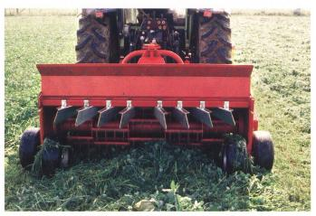
Kurmann K 618 TWIN: Das Breitstreuen des intensiv aufbereiteten Mähgutes erfolgt mit Hilfe von acht verstellbaren Leitblechen.
