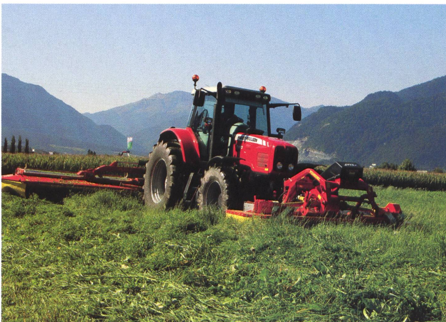
Alle Hersteller haben die Aufhängevorrichtungen (freies Pendeln längs und quer zur Fahrtrichtung) weiter optimiert, um die Boden Anpassung zu verbessern. (Bild: Patricia Wolf)
