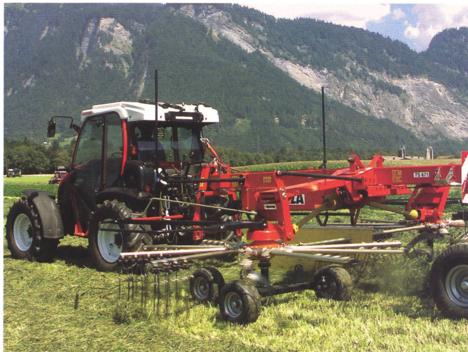
Gezogene Zweikreiselschwader passen sich dank Tasträdern und Tandemachssystemen Unebenheiten im Gelände sehr gut an, und eine relativ bescheidene PS-Klasse beim Zugfahrzeug genügt.
