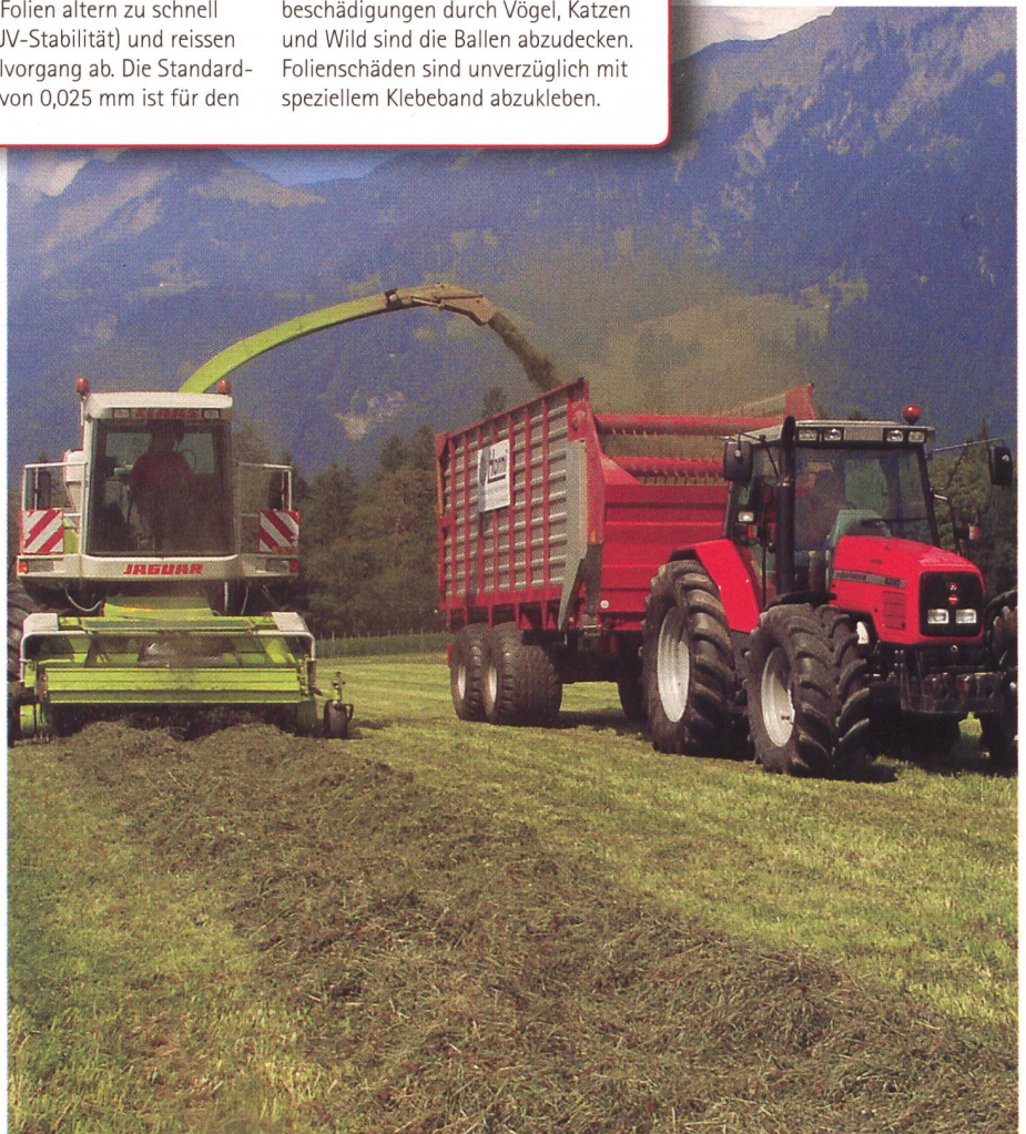
Die Häckslerkette in der Futterbergung ist die eindeutige Domäne der Lohnunternehmer. Sie kann nur wirtschaftlich betrieben werden, wenn Transportleistung auf den Dosierwagen mit der Häckslerleistung optimal korrespondiert. Das exakt gehäckselte Futter wird insbesondere dort verlangt, wo es in einem Hochsilo mit Untenentnahme (Harvestore) gelagert wird.
