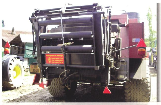
Breitbereifung über 2,55 m bedingt die Immatrikulation als Spezialfahrzeug.
