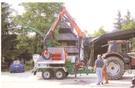
Das ebenfalls ausgestellte Mus-Max-Hackschnitzel-Abladegebläse ist sehr leistungsfähig, kostengünstig und einfach in der Handhabung. Die Schnitzel werden direkt in den Einfülltrog gekippt, welcher mit einer Dosierschnecke versehen ist. Diese versorgt das Gebläse mit der optimalen Fördermenge, und die Schnitzel gelangen mittels Förderrohr sicher in das Schnitzel-Lager.
