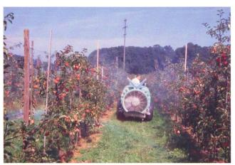
Abb. 4: Eine schmale Baumhecke erfordert eine entsprechend reduzierte Brühemenge/ha und Luftleistung. Axialgebläse ohne Aufsatz (Berthoud).
