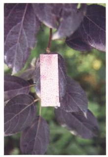
Abb. 6: Mit wassersensitivem Papier wurden die Vertikalverteilung und die Anlagerung auf beiden Blattseiten (rechts) überprüft.
