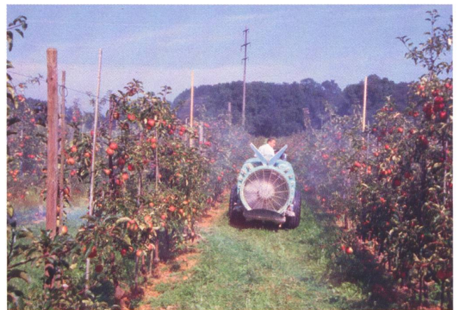
Abb. 4: Eine schmale Baumhecke erfordert eine entsprechend reduzierte Brühmenge/ha und Luftleistung. Axialgebläse ohne Aufsatz (Berthoud).
