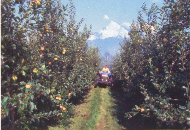
Abb. 2: Anlagen mit einem grossen Baumvolumen erfordern eine gutes Abstimmen der Luftleistung und der Fahrgeschwindigkeit. Dies ist durch eine manuelle stufenlose Schaufelwinkelverstellung möglich (Tifone).
