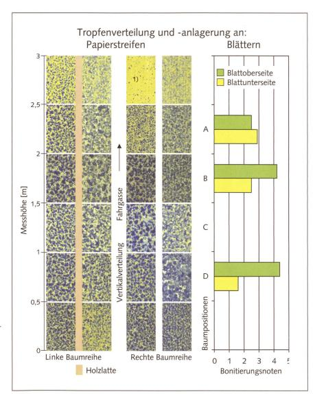
Abb. 9: Vertikalverteilung und Tropfenanlagerung an Blättern (Berthoud). 1) Düse geschlossen
