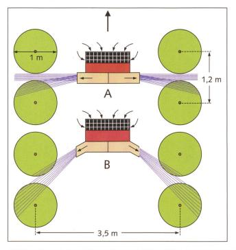
Abb. 10: Schema der Arbeitsweise des Sprühgerätes mit Umkehraxialgebläse:
