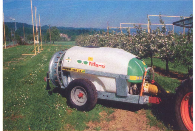
Abb. 2: Anlagen mit einem grossen Baumvolumen erfordern eine gutes Abstimmen der Luftleistung und der Fahrgeschwindigkeit. Dies ist durch eine manuelle stufenlose Schaufelwinkelverstellung möglich (Tifone).
