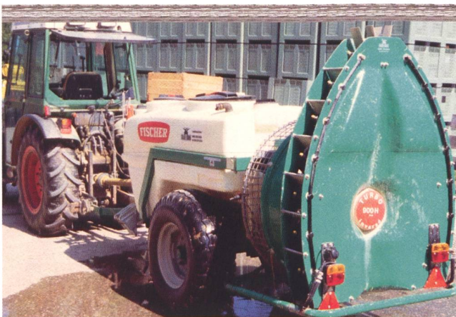
Abb. 3: Anhänger mit drehbarer Zugdeichsel zeichnen sich durch Spurtreue und gute Wendigkeit aus. Durch Luftansaugen von vorne findet kaum ein Wiederansaugen der Tropfen statt (Fischer).
