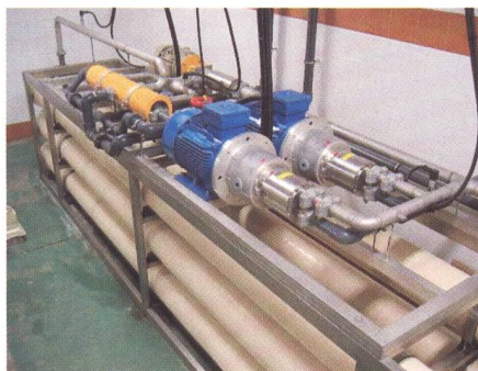
Wasserhydraulikanwendung in einer Anlage zur Klärung von Wasser durch Umkehrosmose
