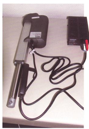
Der Linearantrieb LA36 mit 600 mm Hublänge liefert eine Druck- und Zugkraft von bis zu 6800 N.
