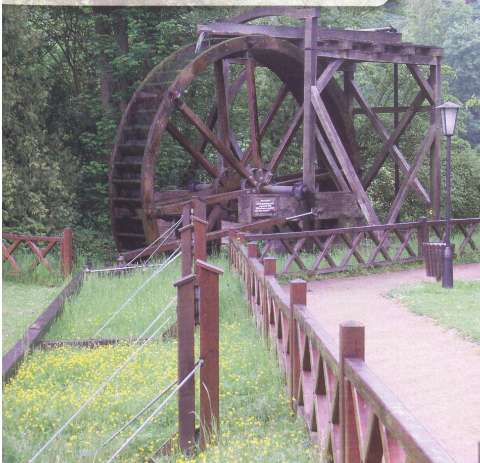
Ein Beispiel für Wasserhydraulik des vorletzten Jahrhunderts: Die Drehbewegung des Wasserrades wurde über ein Holzgestänge umgelenkt und die Kraft dazu verwendet, salzhaltiges Wasser (Sole) aus der Tiefe hochzupumpen. (Bild: Ueli Zweifel. Aufgenommen in Bad Salzhausen in der hessischen Region Vogelsberg.)
