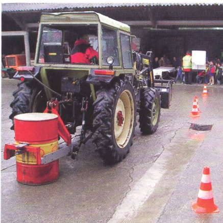
Eingeschränkte Sicht, dargestellt durch die Markierungen: Der Fahrer sieht ein Kind zwischen Traktor und Markierungen
