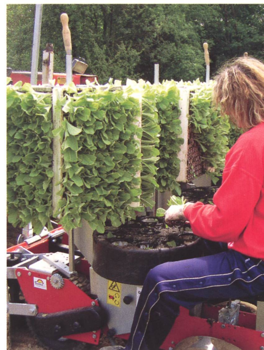
Halbautomatische Pflanzmaschine: Die in das Karussell hinein-gestellten Pflanzen werden automatisch in den Boden eingelassen. (Bilder: J.-F. Vonnez)
