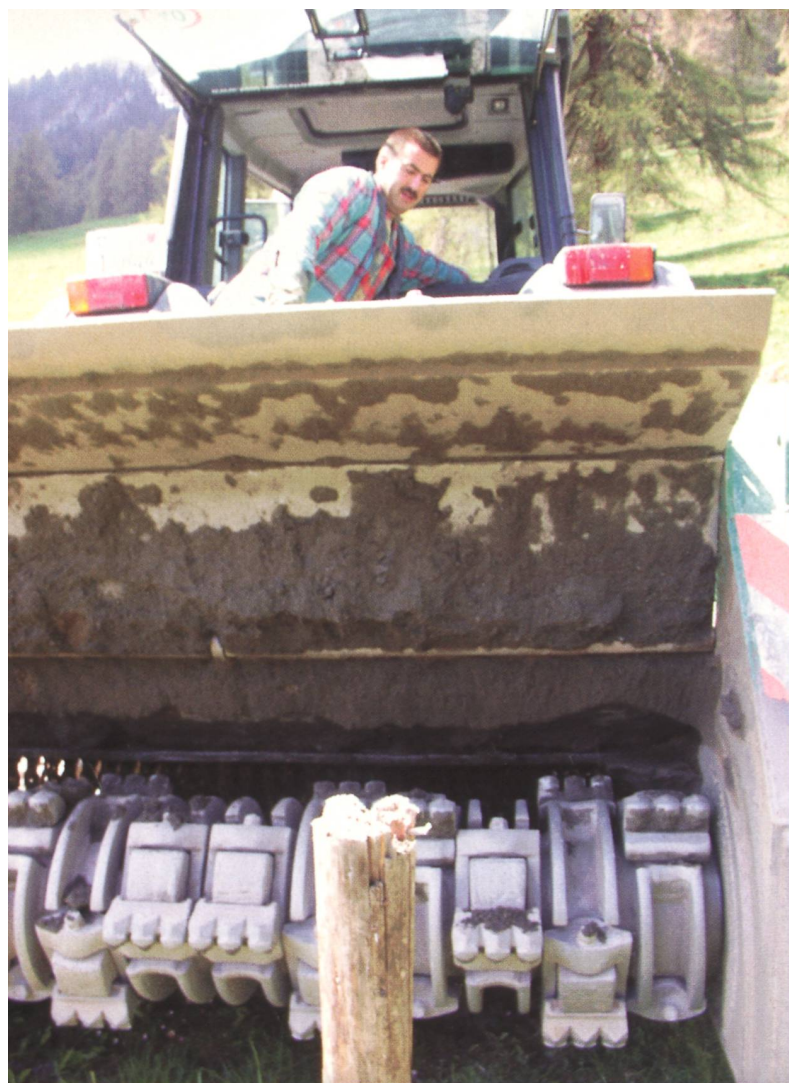
Unbewegliche Schlaghämmer an der Walze zertrümmern das Gesteinsmaterial an der Gegenkante. In einem Arbeitsgang wird das Material zum Beispiel von einer Grösse zwischen 0 und 300 mm auf eine Körnung von 0/30 verkleinert.
