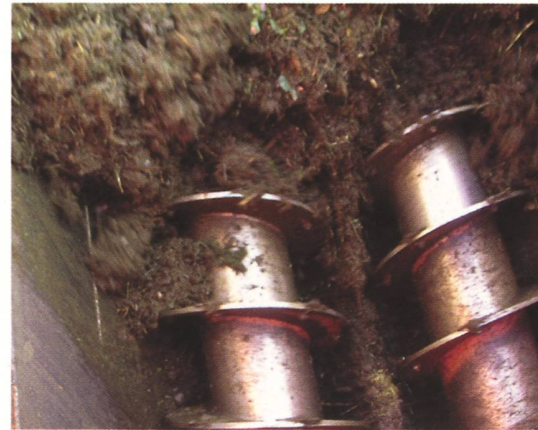
Zwei Schneckenwalzen mit Schneidwerkzeugen zerkleinern und vermischen die Abfälle.
