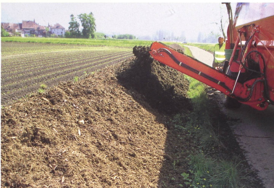
In wenigen Minuten werden bis zu sieben Tonnen aufbereitete Grüngutabfälle entladen und über ein Förderband direkt auf der Miete aufgeschichtet.
