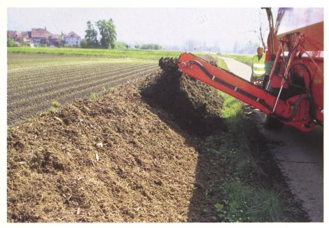
In wenigen Minuten werden bis zu sieben Tonnen aufbereitete Grüngutabälle entladen und über ein Förderband direkt auf der Miete aufgeschichtet.
