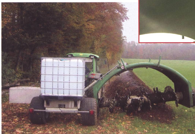
Arbeitsvereinfachung: 1000-Liter-Tank für die Mietenberieselung über fest installierte Düsen im Tunnel.
