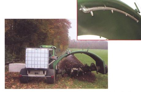
Arbeitsvereinfachung: 1000-Liter-Tank für die Mietenberieselung über fest installierte Düsen im Tunnel.
