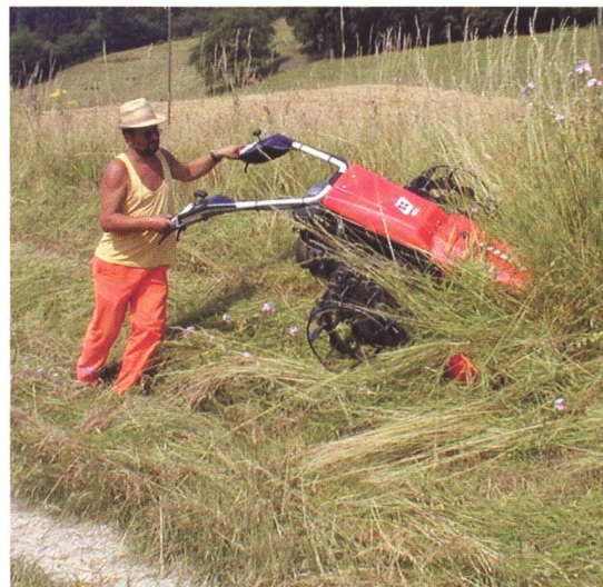
Reform M3 D mit sperrbarer Differenzialachse (Werkfoto).
