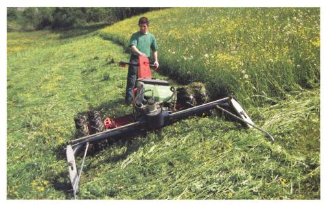
Rapid Tecno mit hydraulischem Fahr- und Geräteantrieb (Werkfoto).
