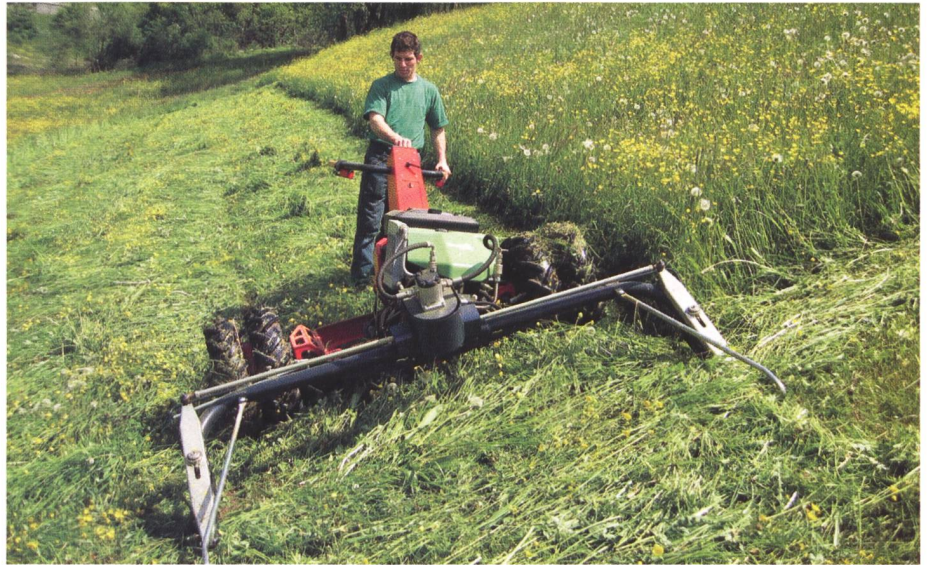
Rapid Tecno mit hydraulischem Fahr- und Geräteantrieb (Werkfoto).
