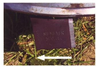
Abb. 2: Scharfe, fabrikneue Mähklinge (Pfeil entspricht Drehrichtung).
