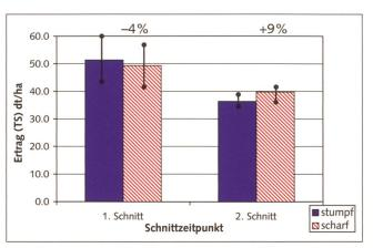
Abb. 5: Einfluss der Klingenschärfe auf den Ertrag beim ersten und zweiten Schnitt. Die Summe der beiden Schnitte ergab bei beiden Verfahren denselben Ertrag.
