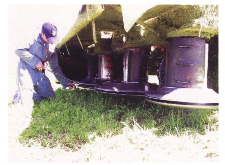
Abb. 1: Klingen wechseln reduziert den Kraftstoffverbrauch.
