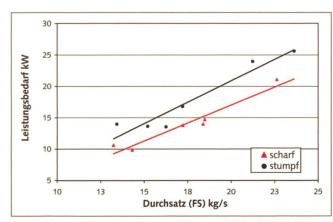
Abb. 9: Der Leistungsbedarf eines Rotorschneidwerks steigt bei stumpfen Messern um zirka 3 kW an (Grassilage, TS Gehalt 24 bis 30%).
