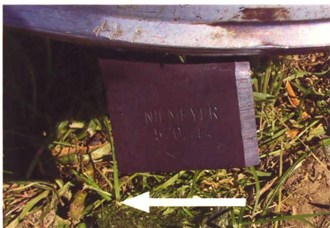
Abb. 2: Scharfe, fabrikneue Mähklinge (Pfeil entspricht Drehrichtung).
