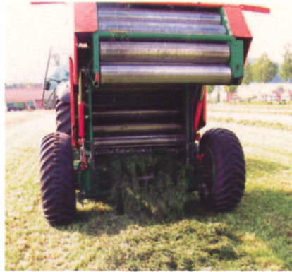
Abb. 7 und Abb. 8: Die Messungen erfolgten in zwei Schritten. Im ersten Schritt wurde der Schwad aufgenommen, geschnitten und wieder abgelegt (Messung des Leistungsbedarfs). Im zweiten Schritt wurde das Gut zu Ballen gepresst (Messung des Ertrags).
