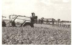
und grosse Arbeitsbreiten. Es kann zwischen 28001 und 38001 Tankvolumen gewählt werden. Verschiedene Gestängevarianten zwischen 15 und 27 m stehen zur Verfügung.
