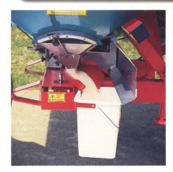
Die Abdrehprobe wird in reeller Fahrgeschwindigkeit durchgeführt, denn der Auffangeimer kann direkt unter den Düngerstrom geschwenkt werden und ist dort fixiert.
