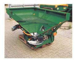
Amazone betont die gleichmässige und schonende Übernahme der Düngerkörner auf die Streuscheibe nahe am Drehzentrum und durch ein speziell konstruiertes Rührelement im Düngertrichter.
