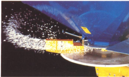
Trend-Streusystem mit gegenläufiger Drehrichtung zum Normalstreuen ...
