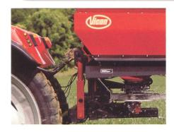
Zum Grenzstreuen können die RotaFlow-Modelle entweder mit einer Randstreuplatte (beim Fahren am Feldrand) oder einem Schrägstellzylinder (beim Fahren in der ersten Fahrgasse) ausgerüstet werden. Hinzu kommt bei den Modellen RS.XL und RS-EDW die Option für das «TrimFlow-System», ähnlich dem Telimat bei Rauch.
