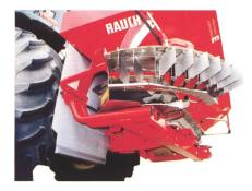
Der «Telimat» wird als Zubehör für fernbedientes Grenz- und Randstreuen hydraulisch in den Düngerstrom geschwenkt und ermöglicht ein genaues Grenz- oder Randstreuen links für alle möglichen Arbeitsbreiten. Mit dem «Telimat» wird die EU-Umweltnorm für Düngerstreuer EN 13739-1 erreicht.
