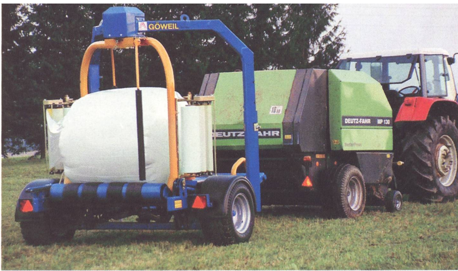
Pressen und Wickeln in einem Arbeitsgang und doch zwei separate Maschinen bedeuten mehr Flexibilität des Lohnunternehmers je nach Kundenwünschen und Betriebsstruktur.
