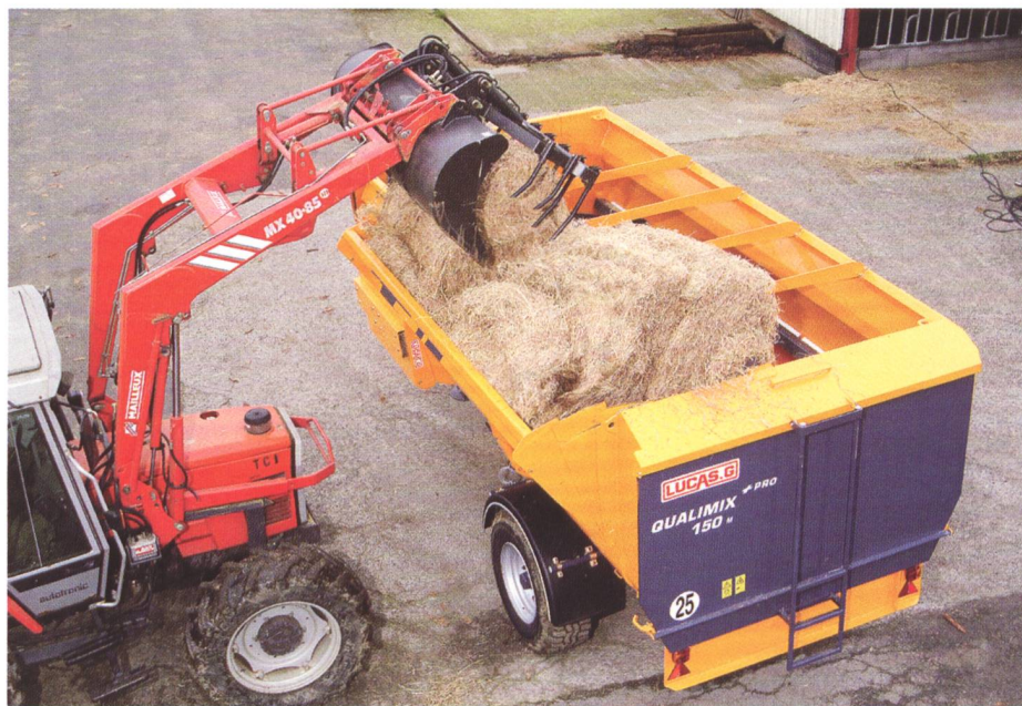
Qualimix-Futtermischer von Lucas, ausgerüstet mit einem Flügelrad und zwei Mischschnecken, kann dank regulierbarer Befüllöffnung mit allen Futterkomponenten beschickt werden. Ein spezielles Schneidsystem zerkleinert die Fasern und unterstützt eine homogene Futtermischung (Werksfoto).
