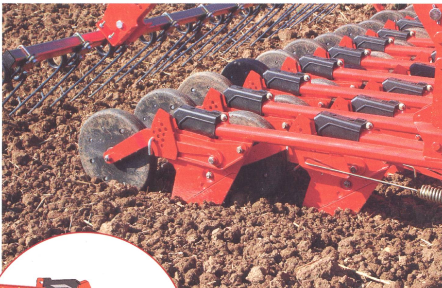
So genannte Kaskaden-Säschar von Kuhn, Saverne, für die genaue Säablage. Die Kaskadenelemente können je nach Sämerei ausgetauscht werden. (Werksfotos)
