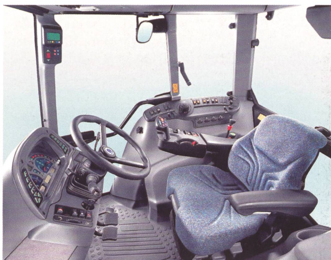
Mit stufenlosem Lastschaltgetriebe übernimmt der Multifunktionshebel «AutoController» der Serie TVT von New Holland in der rechten Armlehne die Vorselektion von u. a. der Geschwindigkeit, der Zapfwellendrehzahl und der Gerätemanipulationen am Vorgewende.
