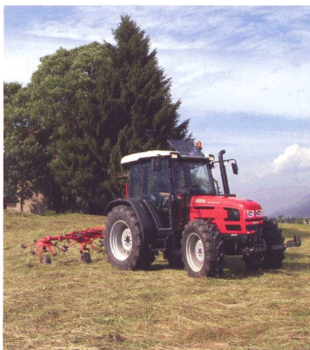
Same-Baureihe Dorado mit mit neuem Fahrmodus «Stop and go». Die Fahrtrichtung und die Halteposition können mit dem Bremspedal gewählt werden, ohne das Kupplungspedal zu benutzen. (Werksfoto)
