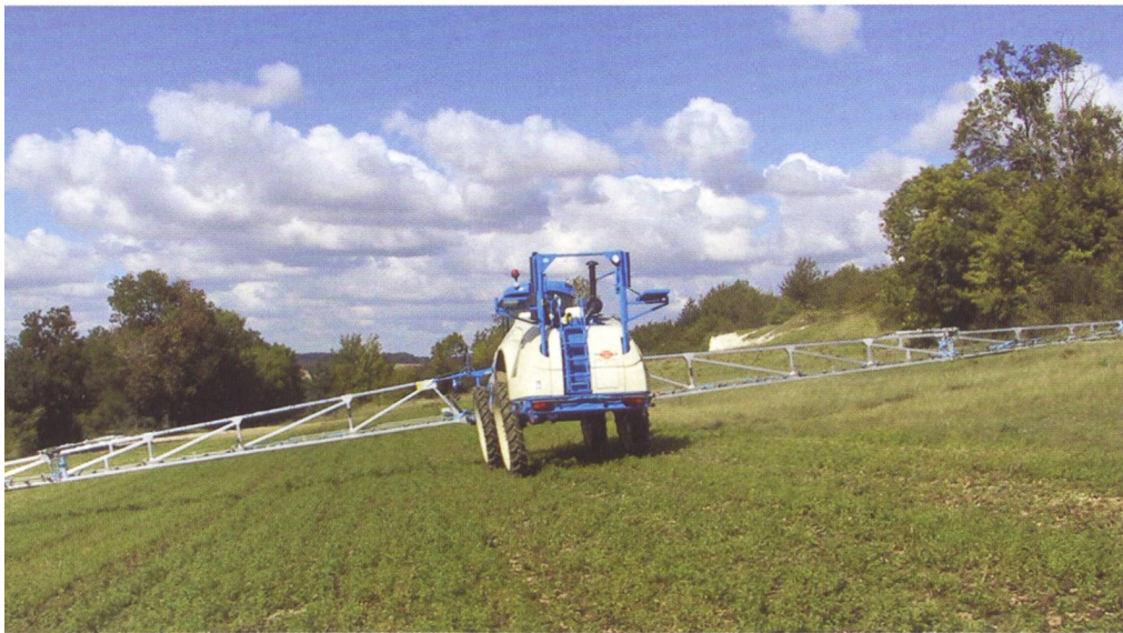
Matro erhält für seine hydraulisches System Stabils eine Goldmedaille. Das System sorgt an Hanglagen für die Parallelführung des Spritzbalkens zum Boden, während der Apparat selbst in Horizontalposition bleibt (Werksfoto).
