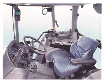
Mit stufenlosem Lastschaltgetriebe übernimmt der Multifunkionshebel «AutoController» der Serie TVT von New Holland in der rechten Armlehne die Vorselektion von u. a. der Geschwindigkeit, der Zapfwellendrehzahl und der Gerätemanipulationen am Vorgewende.
