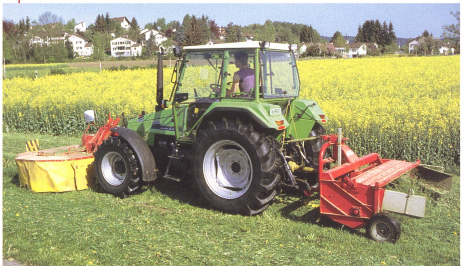
Anfang 90er-Jahre verbessert Deutz die Sicht zum Frontgerät mit der nach unten gezogenen Motorhaube entscheidend. Alle Marken bringen in der Folge einen Freisichttraktor. Allrad und Doppelbereifung bringen mehr Sicherheit am Hang.
