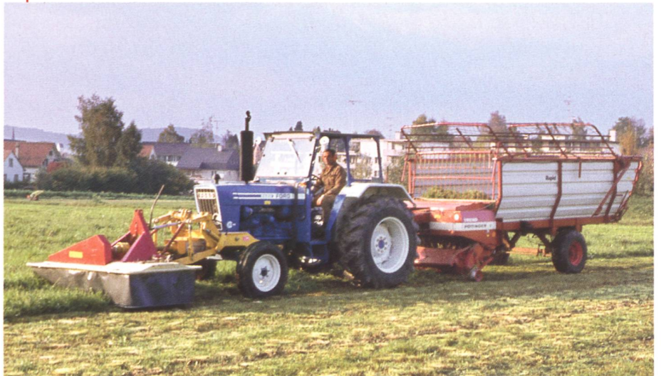
...der Standardtraktor erhält Frontzapfwelle und Hydraulik. Doch die einfache Lenkachse ist den neuen Belastungen noch nicht gewachsen.
