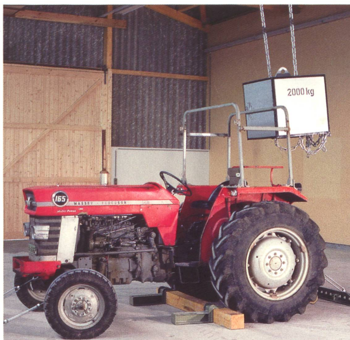
1978: Das Sicherheitsrahmen-Obligatorium macht an der FAT den Prüfstand nötig. Die Gewährleistung des Fahrerschutzes im Unglücksfall wird heute mit sanfteren Methoden mittels Hydraulikzylindern geprüft.
