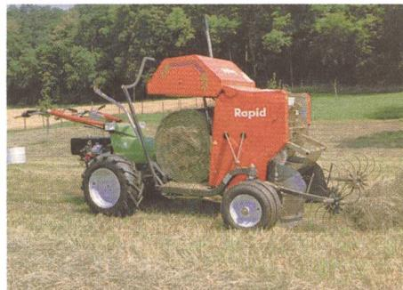
Person alleine dem bestehenden Rapid-Motormäher vorgehängt werden. Als Trägerfahrzeug wird der wendige und einfach zu bedienende Rapid Euro mit hydraulischem Radantrieb bevorzugt. Motorleistungen bis zu 20 PS bewirken ein effizientes Arbeiten. Einzigartig bei dieser Kombination ist die Aktivlenkung, welche sowohl für das Grundfahrzeug als auch für das Anbaugerät gilt.
