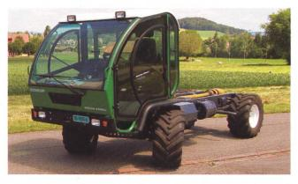
Transporter SCHILTRAC 2068 SF, 4-Zlinder-Turbomotor mit 65 kW (88 PS), 2-Stufen-Lastschaltgetriebe, Komfortkabine, Achsfederung vorne und hinten, Leergewicht 2660 kg, zulässiges Gesamtgewicht 7000 kg, (Listenpreis CHF 107 600.–), Testbericht-Nr. 1863/04.
