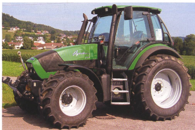
Traktor DEUTZ-FAHR Agrotion 118, 6-Zylinder-Turbomotor mit Ladeluftkühlung, 93,5 kW (127 PS), 4-Stufen-Lastschaltgetriebe, Fronthydraulik und Frontzapfwelle, Vorderachsfederung, Kabinenfederung, Gewicht 6250 kg, (Listenpreis CHF 125 300.-), Traktortest-Nr. 1867/04.
