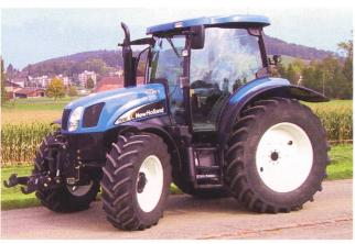
Traktor NEW HOLLAND TS 110A, 4-Zylinder-Turbomotor mit Ladeluftkühlung, 85 kW (116 PS), (Power Boost +21,7 kW), 8-Stufen-Lastschaltgetriebe, Fronthydraulik und Frontzapfwelle, Vorderachsfederung, Kabinenfederung, Gewicht 5790 kg, Sparvariante ECO-Tronic (Listenpreis CHF 138070.–), Traktortest-Nr.1874/04.
