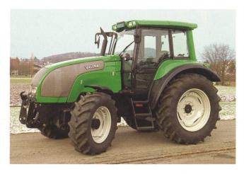
Traktor VALTRA M130-4, 4-Zylinder-Turbomotor mit Ladeluftkühlung, 95,5 kW (130 PS), 3-Stufen-Lastschaltgetriebe, Fronthydraulik, Vorderachsfederung, Gewicht 5840 kg, (Listenpreis CHF 127 840.–), Testbericht Nr. 1859/04.
