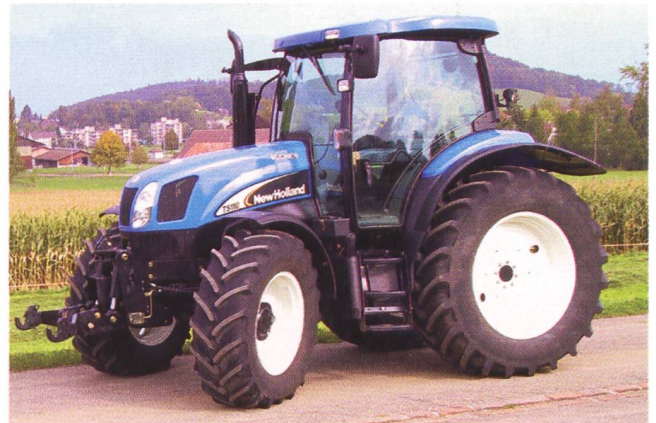
Traktor NEW HOLLAND TS 110A, 4-Zylinder-Turbomotor mit Ladeluftkühlung, 85 kW (116 PS), (Power Boost +21,7 kW), 8-Stufen-Lastschaltgetriebe, Fronthydraulik und Frontzapfwelle, Vorderachsfederung, Kabinenfederung, Gewicht 5790 kg, Sparvariante ECO-Tronic (Listenpreis CHF 138 070.-), Traktortest-Nr. 1874/04.
