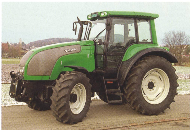
Traktor VALTRA M130-4, 4-Zylinder-Turbomotor mit Ladeluftkühlung, 95,5 kW (130 PS), 3-Stufen-Lastschaltgetriebe, Fronthydraulik, Vorderachsfederung, Gewicht 5840 kg, (Listenpreis CHF 127 840.-), Testbericht Nr. 1859/04.
