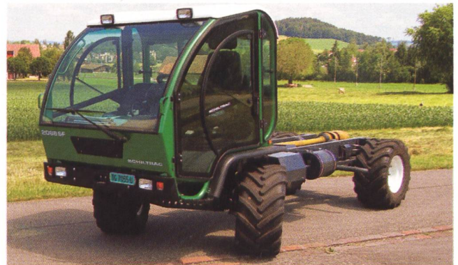
Transporter SCHILTRAC 2068 SF, 4-Zylinder-Turbomotor mit 65 kW (88 PS), 2-Stufen-Lastschaltgetriebe, Komfortkabine, Achsfederung vorne und hinten, Leergewicht 2660 kg, zulässiges Gesamtgewicht 7000 kg, (Listenpreis CHF 107 600.-), Testbericht-Nr. 1863/04.
