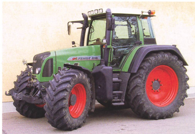
Traktor FENDT 818 Vario, 6-Zylinder-Turbomotor mit Ladeluftkühlung, 132 kW (180 PS), stufenloses Fahrgetriebe, Fronthydraulik, Vorderachsfederung, Kabinenfederung, Gewicht 7150 kg, (Listenpreis CHF 204 978.-), Testbericht Nr. 1860/04.
