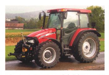
Traktor Case IH JXU 1090U, 4-Zylinder-Turbomotor 65 kW (88 PS), 2-Stufen-Lastschaltgetriebe, Fronthydraulik und Frontzapfwelle, Gewicht 4370 kg, (Listenpreis CHF 94 900.–), Traktortest-Nr.1873/04.
