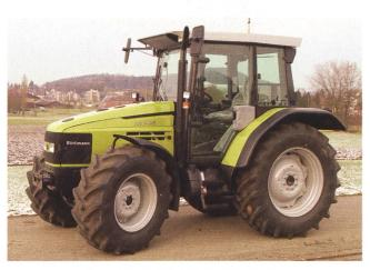
Traktor HÜRLIMANN XT 95, 4-Zylinder-Turbomotor, 67 kW (91 PS), 3-Stufen-Lastschaltgetriebe, Gewicht 4120kg, (Listenpreis CHF 87 000.–), Testbericht Nr. 1862/04.
