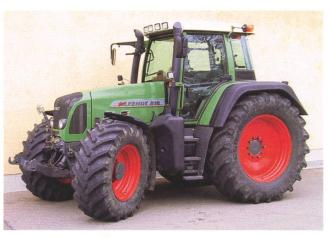
Traktor FENDT 818 Vario, 6-Zylinder-Turbomotor mit Ladeluftkühlung, 132 kW (180 PS), stufenloses Fahrgetriebe, Fronthydraulik, Vorderachsfederung, Kabinenfederung, Gewicht 7150 kg, (Listenpreis CHF 204978.–), Testbericht Nr. 1860/04.
