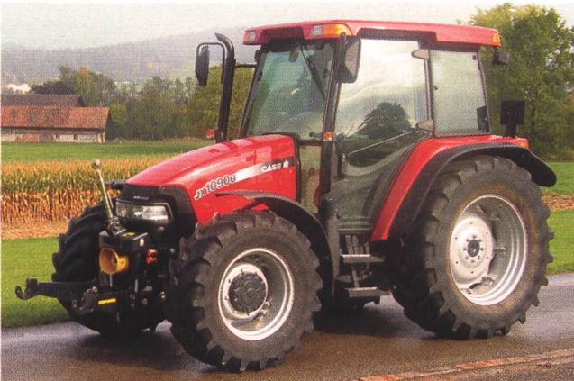
Traktor Case IH JXU 1090U, 4-Zylinder-Turbomotor 65 kW (88 PS), 2-Stufen-Lastschaltgetriebe, Fronthydraulik und Frontzapfwelle, Gewicht 4370 kg, (Listenpreis CHF 94 900.-), Traktortest-Nr. 1873/04.
