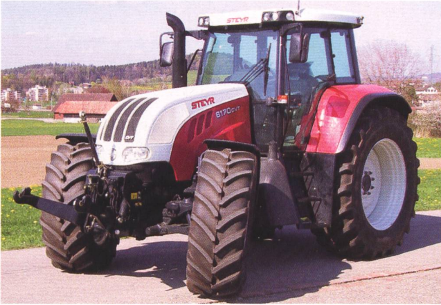
Traktor STEYR CVT 6170, 6-Zylinder-Turbomotor mit Ladeluftkühlung, 114 kW (155 PS), stufenloses Fahrgetriebe, Fronthydraulik, Vorderachsfederung, Kabinenfederung, Gewicht 7490 kg, (Listenpreis CHF 180 450.-), Testbericht Nr. 1861/04.
