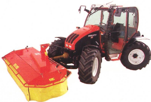
Bergtraktor REFORM Mounty 80 S, 4-Zylinder-Turbomotor mit 59 kW (80 PS), synchronisiertes Wendegetriebe, Fronthydraulik und Frontzapfwelle, Gewicht 2860 kg, (Listenpreis CHF 97 798.-), Testbericht Nr. 1865/043. Auszug aus Testbericht der Bundesanstalt für Landtechnik BLT in Wieselburg (A).
