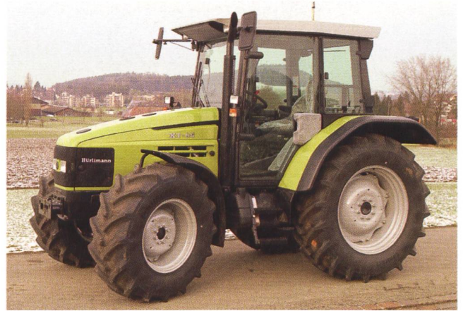
Traktor HÜRLIMANN XT 95, 4-Zylinder-Turbomotor, 67 kW (91 PS), 3-Stufen-Lastschaltgetriebe, Gewicht 4120 kg, (Listenpreis CHF 87 000.-), Testbericht Nr. 1862/04.
