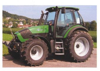
Traktor DEUTZ-FAHR Agrotron 118, 6-Zylinder-Turbomotor mit Ladeluftkühlung, 93,5 kW (127 PS), 4-Stufen-Lastschaltgetriebe, Fronthydraulik und Frontzapfwelle, Vorderachsfederung, Kabinenfederung, Gewicht 6250 kg, (Listenpreis CHF 125 300.–), Traktortest-Nr.1867/04.
