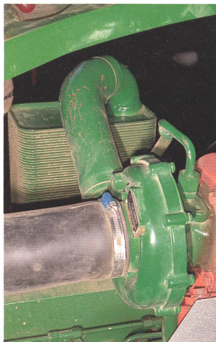
Abb. 5: Der wassergekühlte Ladeluftkühler (zum Beispiel John Deere) ist in den Abmessungen kleiner, und die Einbaulage ist annähernd frei wählbar. Die Ladeluft kann nur bis in die Nähe der Kühlmitteltemperatur heruntergekühlt werden.
