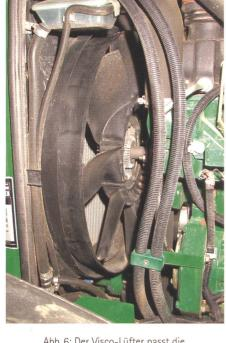
Abb. 6: Der Visco-Lüfter passt die Drehzahl und damit die Kühlluftrate mittels geregelter Flüssigkeitskupplung automatisch dem Kühlbedarf des Motors an.
