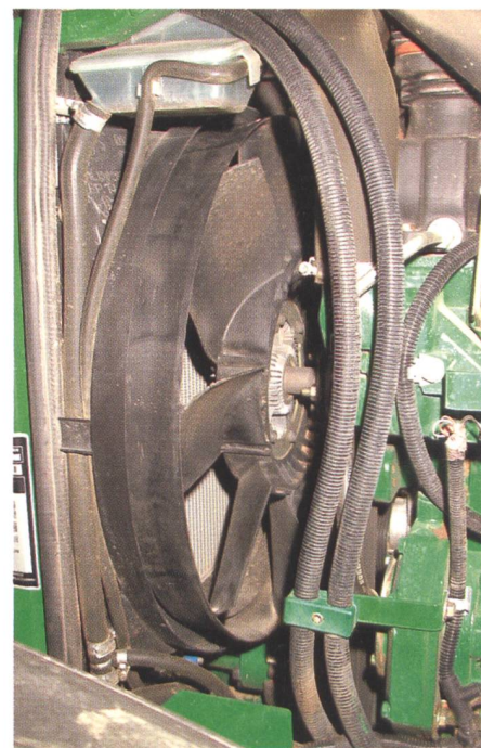
Abb. 6: Der Visco-Lüfter passt die Drehzahl und damit die Kühlluft rate mittels geregelter Flüssigkeitskupplung automatisch dem Kühlbedarf des Motors an.
