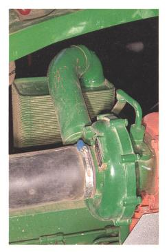
Abb. 5: Der wassergekühlte Ladeluftkühler (zum Beispiel John Deere) ist in den Abmessungen kleiner, und die Einbaulage ist annähernd frei wählbar. Die Ladeluft kann nur bis in die Nähe der Kühlmitteltemperatur heruntergekühlt werden.
