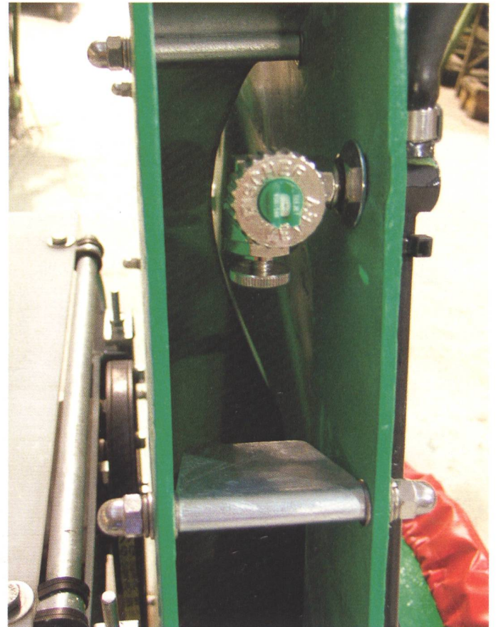
Fig. 5: Die Ausrichtung der Abweisbleche erlaubt es, den Luftstrom zu richten und so eine optimale Schutzwirkung zu erzielen.
