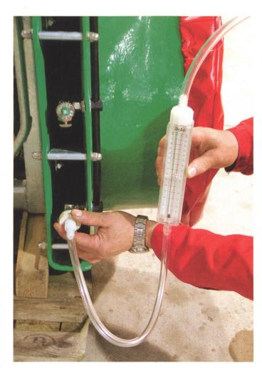
Fig 3: Ein Durchflussmesser erleichtert die Arbeit (Bild: Fischer Nouvelle S. à r. l. in Collombey-le-Grand).
