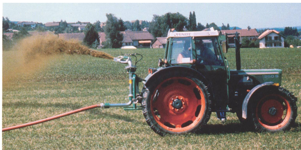
Die Gülleverschlauchung ermöglicht eine starke Gülleverdünnung, ohne dass die Ausbringkosten merklich zunehmen. Ein hoher Wasserzusatz macht die Gülle fließfähiger und reduziert die Ammoniakverluste.
