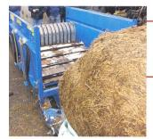
Göweil Ballenauflöser, ab CHF 8000.-\* Göweil GmbH, 4950 Huttwil Antrieb hydraulisch, Abladehöhe bis 100 cm, Leergewicht 600 kg, Breite 215 cm
