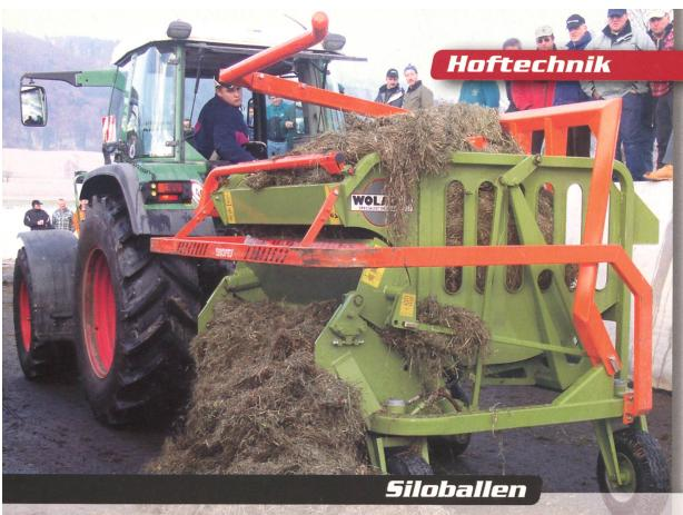
Die Ballenaufschneidund -abwickelgeräte sind eine junge Maschinengruppe. Verblüffend vielfältig präsentieren sich deshalb die Gerätekonstruktionen. Dieses Gerät fiel durch die gleichmässige Ablage und die sehr gute Auflockerung des Futters auf. Beides hängt offenbar damit zusammen, dass das Futter geschnitten und portionenweise ausgeworfen wird.
