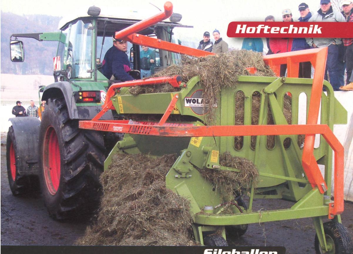
Die Ballenaufschneid- und -wickelgeräte sind eine junge Maschinengruppe. Verblüffend vielfältig präsentieren sich deshalb die Gerätekonstruktionen. Dieses Gerät fiel durch die gleichmässige Ablage und die sehr gute Auflockerung des Futters auf. Beides hängt offenbar damit zusammen, dass das Futter geschnitten und portionenweise ausgeworfen wird.
