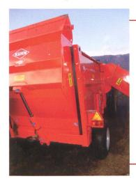
CHF 27 380.-\* **Agriott, 3052 Zollikofen**Antrieb: mechanisch, Regulierung elektronisch (Potenziometer), Hydraulikanschluss doppelwirkend, Ladeklappe oder Frontlader, L×B×H (cm): 394×220×230 Ladeklappe oder Frontlader, Weitere Einsatzmöglichkeiten: Stroh einstreuen bis 18 m, Rund- und Quaderballen, sowie loses Futter, elektrische Bedienung, Polydrive®-Antrieb, zusätzl. Bedienung der Ladeklappe hinten
