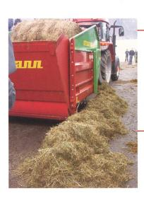
Agro-Technik Zulliger GmbH, 4919 Reisiswil BE Antrieb hydraulisch/ mechanisch, hydraulische Ladeklappe, Leergewicht 1600 kg, L×B×H (cm): 380×230×180, Abladehöhe bis 50 cm, für Rund- und Quaderballen. Heu.
