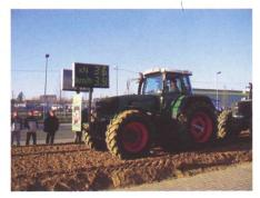
Demonstration: Reifendruckabsenkung hilft Treibstoff sparen.
