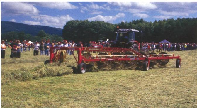
Die Wiedergeburt des Sternradrechens? Der italienische Hersteller Tonutti zeigte einen gezogenen zweiteiligen Sternradrechenschwader mit mittiger Ablage, 2x7 Sternrädern und 8,5 m Räumbreite. Dank der hohen Arbeitsgeschwindigkeit von bis zu 20 km/h ergibt sich eine hohe Flächenleistung. Eine weiterer Vorteil ist die sehr schonende Futterbehandlung.
