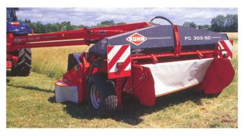
Der gezogene Scheibenmäher Kuhn FC 303 GC mit 6 Scheiben und 3 m Arbeitsbreite hat eine mittig angebrachte Zugdeichsel. Der integrierte Aufbereiter besteht aus pendelnden Stahlschlägeln.
