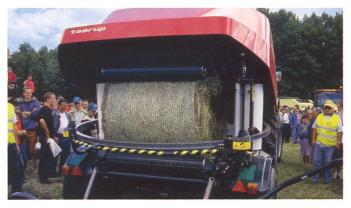
Taarup hat seine Rundballenpresse BIO (Bale in one) mit integriertem Wickler in der Presskammer weiter perfektioniert. Das Pressen und Wickeln im gleichen Arbeitsgang reduziert die Kosten und die erforderliche Arbeitszeit bei der Silageballengewinnung. Durch das sofortige Einstretchen bietet diese Maschine zudem optimale Voraussetzungen für den Gärprozess im Ballen.
