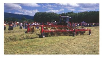
Die Wiedergeburt des Sternradrechens? Der italienische Hersteller Tonutti zeigte einen gezogenen zweiteiligen Sternradrechenschwader mit mittiger Ablage, 2x7 Sternrädern und 8,5 m Räumbreite. Dank der hohen Arbeitsgeschwindigkeit von bis zu 20 km/h ergibt sich eine hohe Flächenleistung. Eine weiterer Vorteil ist die sehr schonende Futterbehandlung.
