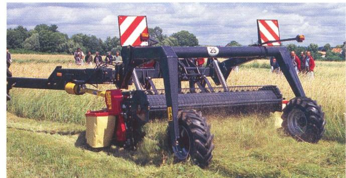
Vicon bietet seinen Intensiv-Mähaufbereiter mit Bürsten- und Riffelwalze auch in gezogener Version (KM 3001 HPC) an. Er eignet sich für die Gewinnung von eintägiger Anwelsilage ohne jeglichen Einsatz des Kreiselheuers.
