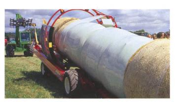
Bei grosser Ballenzahl bietet sich als interessante Alternative zum klassischen Wickelgerät das Verfahren des Strangwicklers an. Mit dieser Maschine lassen sich bis zu 120 Ballen pro Stunde stretchen. Voraussetzung ist jedoch ein gut organisiertes Handling der gepressten Ballen.
