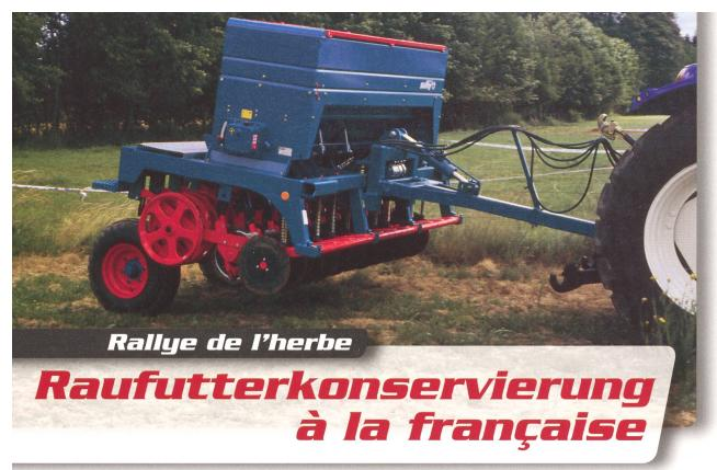
Die gezogene Schlitzsämaschine Sulky Unidrill G 300 mit einem Reihenabstand von 13 cm eignet sich sowohl für Übersaaten als auch für die Erneuerung von sehr lückigen oder mit Totalherbizid behandelten Flächen.
