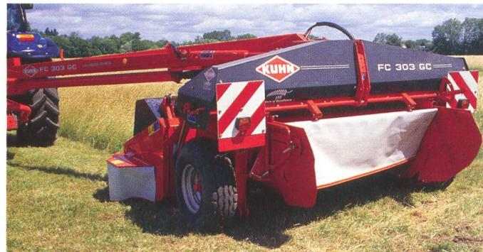
Der gezogene Scheibenmäher Kuhn FC 303 GC mit 6 Scheiben und 3 m Arbeitsbreite hat eine mittig angebrachte Zugdeichsel. Der integrierte Aufbereiter besteht aus pendelnden Stahlschlägeln.
