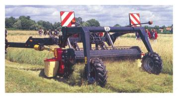
Vicon bietet seinen Intensiv-Mähaufbereiter mit Bürsten- und Riffelwalze auch in gezogener Version (KM 3001 HPC) an. Er eignet sich für die Gewinnung von eintägiger Anwelksilage ohne jeglichen Einsatz des Kreiselheuers.
