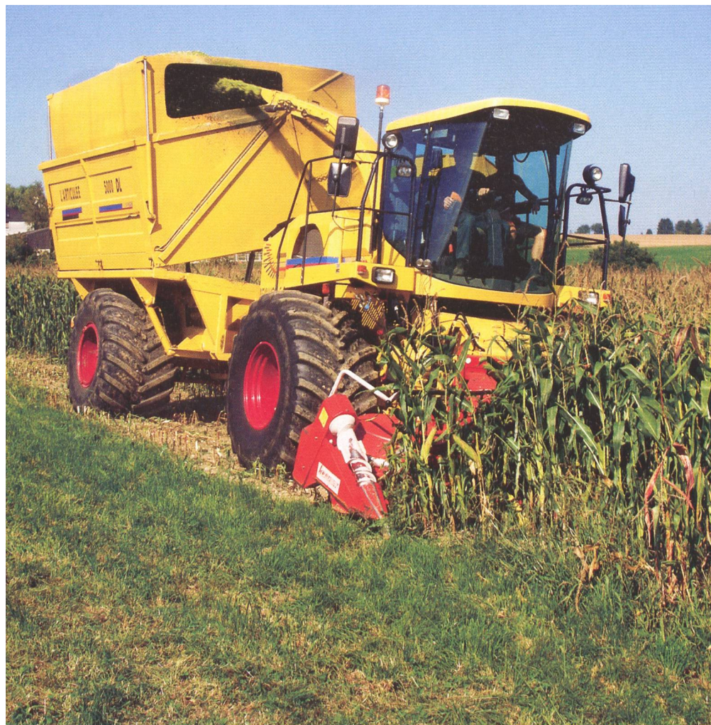
Bunkerfeldhäcksler: vom Transport unabhängiger dank mitgeführter Füllkapazität und Kombi- nierbarkeit mit Wechselladensystemen
