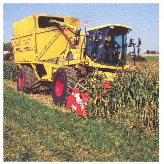
Bunkerfeldhäcksler: vom Transport unabhängiger dank mitgeführter Füllkapazität und Kombinierbarkeit mit Wechselmuldensystemen
