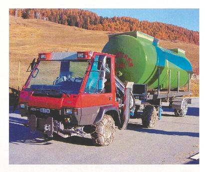
Bei Spezialfahrzeugbau gefertigt und montiert: Aebi TP 98 mit 4 m/t Kranaufbau, Scharmüller K 120 Kupplung und einem Spezialauflieger mit 9 t Gesamtgewicht. (Bild: Peter Meier)
