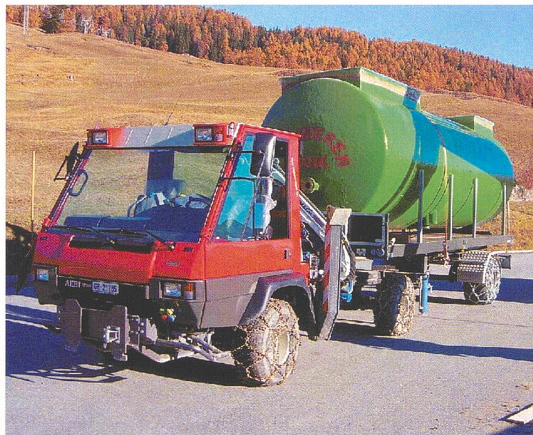
Bei Spezialfahrzeugbau gefertigt und montiert: Aebi TP 98 mit 4 m Kran Aufbau, Scharmüller K 120 Kupplung und einem Spezialaufleger mit 9 t Gesamtgewicht. (Bild: Peter Meier)
