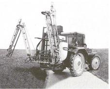
delndem Rahmen, manuelle Steuerung oder Fernsteuerungskasten in der Traktorkabine für alle hydraulischen Funktionen, Druckregulierung, Haupthahn und 5 Sektorventile (Option), Düsenleitung aus Edelstahl mit Quadrix-Düsenkörper und 2 TeeJet-Düsen nach Wahl und vieles andere.
