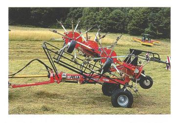
Sechsteilige Kreiselheuer für den Anbau an der Dreipunktydraulik dürften für die meisten Betriebe auch in nächster Zukunft das Richtige sein. Eine Nachlaufeinrichtung, eine optimale Geländeanpassung dank Gelenken und Ballonreifen, eine zentrale Schräglaufeinrichtung für das Grenzzetten sowie das hydraulische Ein- und Ausklappen der Kreiselarme zeichnen die heutigen Kreiselheuer aus.
