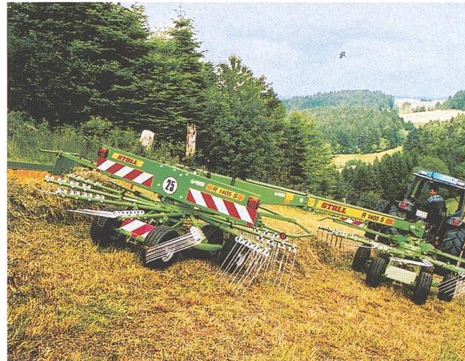
*Zweikreiselschwader stossen auf ein zunehmendes Interesse, das Preis-Leistungs-Verhältnis muss aber stimmen. Die kardanische Aufhängung der Schwadkreisel, Breitspurfahrwerke mit Ballonreifen, ein Fahrgestell mit gelenkten Laufrädern, verstellbare Kurvenbahnsteuerungen und eine verstellbare Schwadbreite gehören heute zu einem modernen Mittenschwader.*
