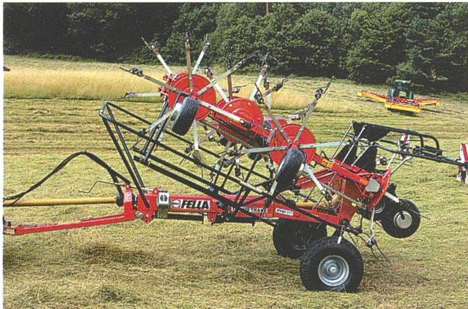
Sechsteilige Kreiselheuer für den Anbau an der Dreipunkthydraulik dürften für die meisten Betriebe auch in nächster Zukunft das Richtige sein. Eine Nachlaufeinrichtung, eine optimale Geländeauspassung dank Gelenken und Ballonreifen, eine zentrale Schräglaufeinrichtung für das Grenzsetzen sowie das hydraulische Ein- und Ausklappen der Kreiselarme zeichnen die heutigen Kreiselheuer aus.
