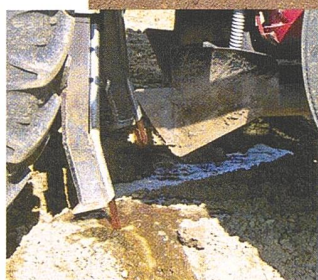
Bei Kartoffeln wird das CULTAN-Depot direkt beim Legen eingebracht. Vorne am Traktor der Tank mit Pumpe für die Düngerlösung bzw. für die aufkonzentrierte Gülle. Direkt vor dem Legeschar ist der Flüssigkeitsinjektor angebracht.
