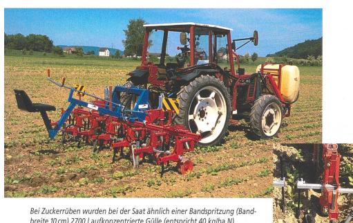
breite 10 cm) 2700 l aufkonzentrierte Gülle (entspricht 40 kg/ha N) als Startergabe ausgebracht. Die Anlage des eigentlichen CULTAN-Depots (Varianten: 40 kg/ha N und 80 kg/ha in 15 cm Bodentiefe) erfolgte in ieden zweiten Zwischenraum von zwei Rübenreihen im 5- bis 6-Blatt-Stadium der Rüben in Kombination mit der Scharhacke.
