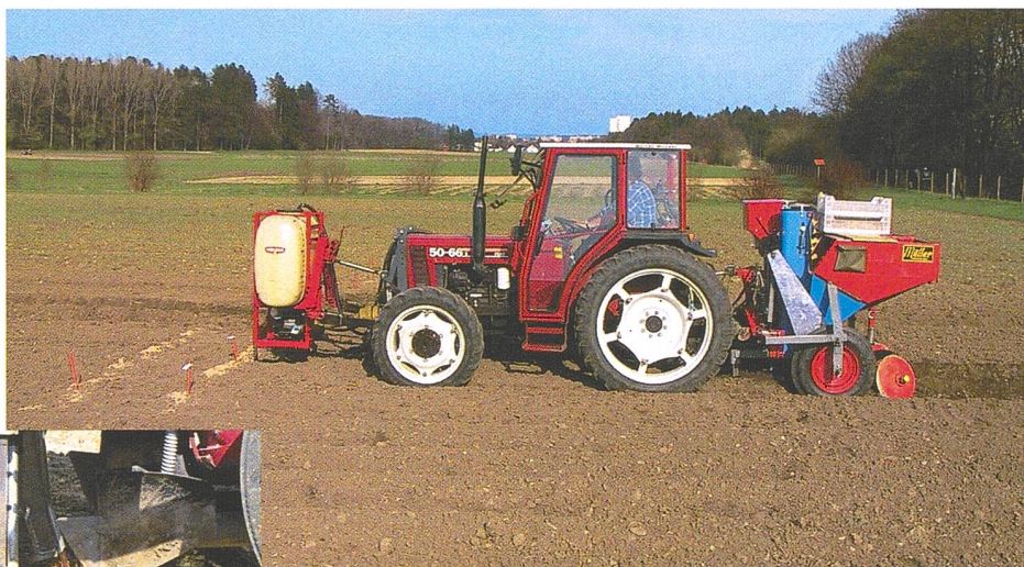
Bei Kartoffeln wird das CULTAN-Depot direkt beim Legen eingebracht. Vorne am Traktor der Tank mit Pumpe für die Düngerlösung bzw. für die aufkonzentrierte Gülle. Direkt vor dem Legeschar ist der Flüssigkeitsinjektor angebracht.
