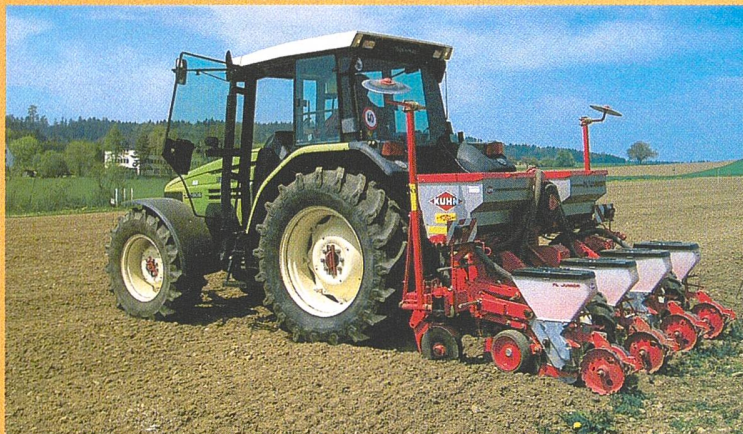
Sämaschine, ausgerüstet für Unterfussdüngung, bei der Anlage des Versuches (Bild Ursula Heiniger, Strickhof).
