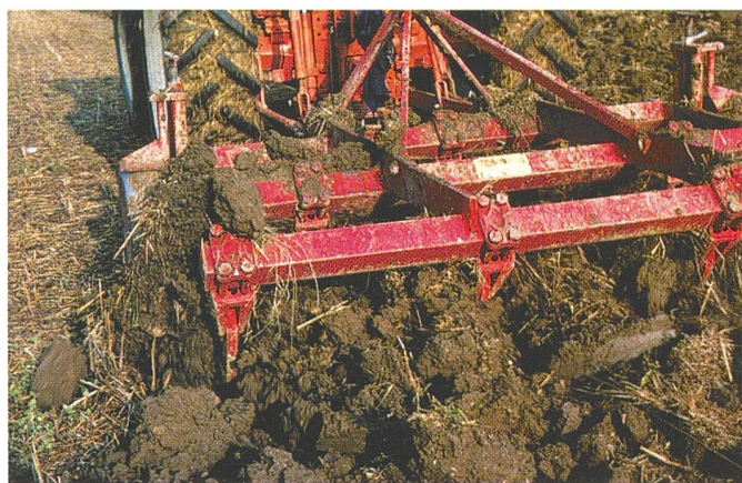
Mit dem Tiefgrubber wird das organische Material in die bearbeitete Schicht regelmässig verteilt. Wenn es um tiefes Lockern geht, so gibt man gegenwärtig dem Flügelchargrubber den Vorzug, weil er die Bodenschichten kaum mischt und das organische Material an der Oberfläche lässt.
