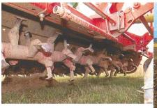
Die Rotoregge ist eine der möglichen Maschinen zur minimalen Bodenbearbeitung. Im Allgemeinen wird ihr die Sämaschine angekuppelt; so wird die Saat gleichzeitig erledigt.
