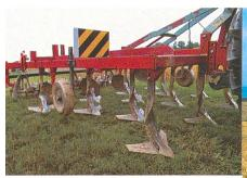
Der Schälgrubber - mit starren Zinken und flach arbeitenden Flügeln ausgestattet – erlaubt eine mitteltiefe und homogene Bodenlockerung mit optimaler Einarbeitung des organischen Materials, insbesondere der Hofdünger.
