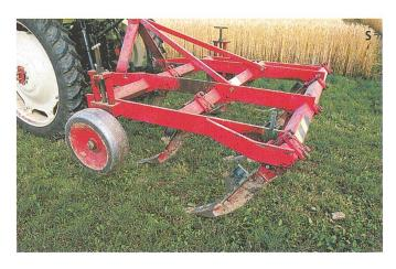
Der Tiefgrubber kann den Boden bis zur Pflugsohle lockern.
