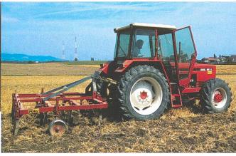
Der Schälgrubber zerstört effizient die installierten Pflanzen und hinterlässt genug organische Substanz in Oberflächennähe, um bereits einen gewissen Schutz der Bodenstruktur sicherzustellen.
