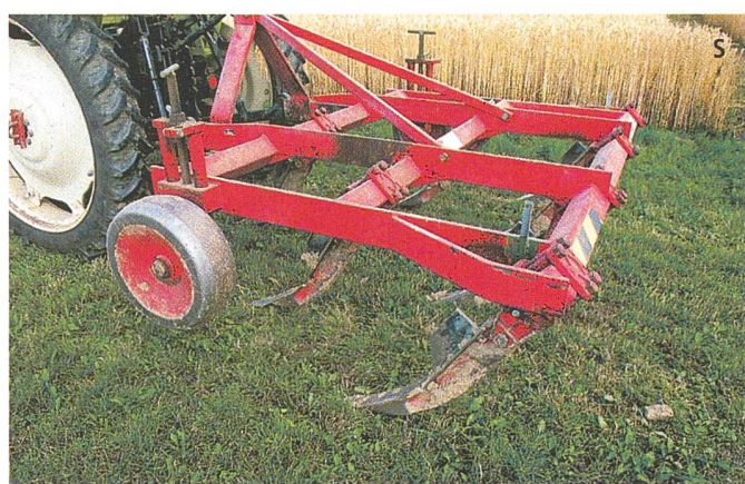
Der Tiefgrubber kann den Boden bis zur Pflugsohle lockern.
