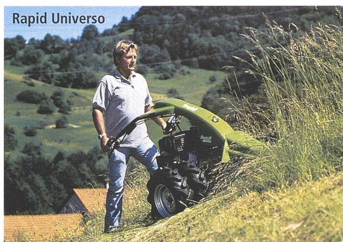
Eine absolute Eigenentwicklung aus dem Hause Rapid ist der Universo. Der Holm ist werkzeuglos um 230 Grad schwenk- und in der Höhe stufenlos verstellbar. Die raffinierte Wendematic erübriggt ein Umdenken durch den Fahrer. Egal wie der Holm steht, die Bedienelemente reagieren immer gleich.
