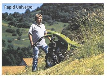
Eine absolute Eigenentwicklung aus dem Hause Rapid ist der Universo. Der Holm ist werkzeuglos um 230 Grad schwenk- und in der Höhe stufenlos verstellbar. Die raffinierte Wendematic erübrigt ein Umdenken durch den Fahrer. Egal wie der Holm steht, die Bedienelemente reagieren immer gleich.
