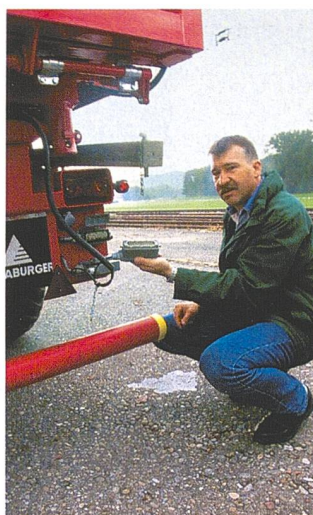
Bruno Naef: «Alle Mess- und Steuerungsimpulse zwischen Terminal und Wechselaufbaute laufen über diese Schnittstelle. Ein gleicher multifunktionaler Anschluss ist links für die Hydraulik vorhanden.
