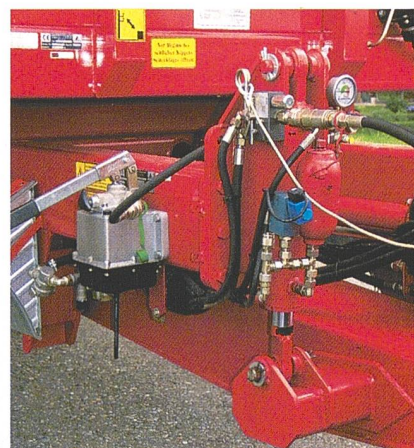
Die hydraulische Federung wirkt über Druckspeicher.
