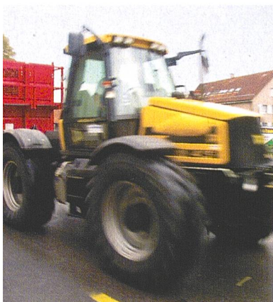
Faszination und Zeitgewinn: JCB-Schnellläufer, zugelassen für die Höchstgeschwindigkeit 50 km/h, in Kombination mit Luftdruckbremsen.
