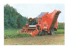
häcksler zwischen die Reihen abgelegte Blattwerk. Der Lenkkopf hinten verfügt über einen Einschlag von 70 Grad. Dadurch ist ein Wenden ohne Manöverbewegungen möglich, und unnötige Überfahrten werden vermieden.
