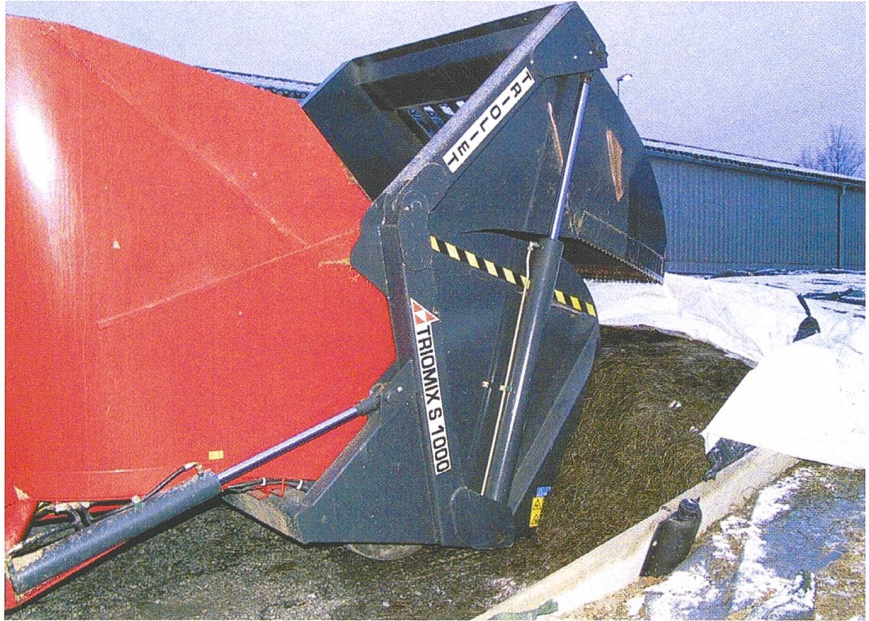
Abb. 3: Selbstbefüller können die Silage am Flachsilo dank einer Fräse, einem Reisskamm oder wie im Bild mit einem Schneidschild entnehmen.
