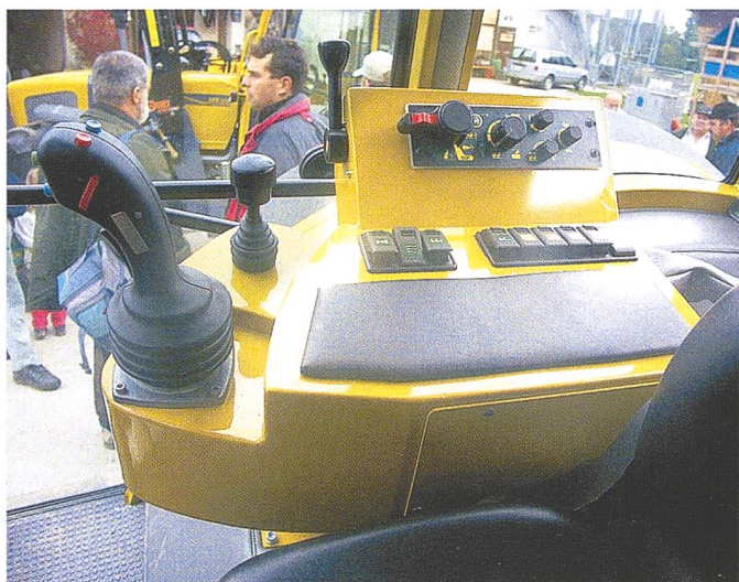
Auf der rechten Konsole: Joystick (mit Taste für die Rückwärtsfahrt), Fahrhebel für die Vorwahl des Geschwindigkeitsbereichs, Handgas und Vorwahl des Fahrmodus sowie sehr übersichtliche Anordnung von Zapfwelle und 3-Punkt-Hydraulik.
