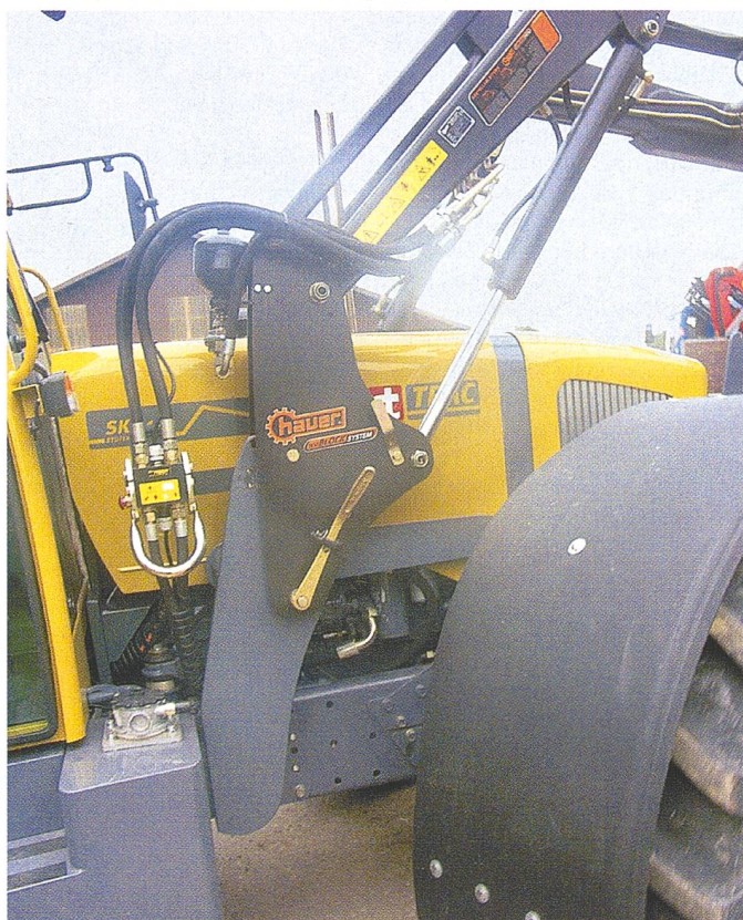
Über die Montage am Vorderteil des Chassis kommt es zur starren Verbindung des Frontgeräteanbaus mit der Carraro-Vorderachse.
