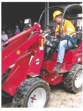
Perfekt ausgerüsteter Knicklenker mit Sicherheitsgurt, Bügeln links und rechts sowie einem Schutzdach.
