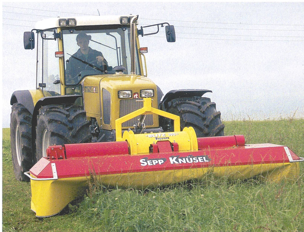
Small is beautiful... und doch 120 PS unter der Haube, deren Kühlergrill vorne und seitlich viel, aber relativ langsam zirkulierende Luft durchlässt. Diese strömt an den Kühlereinheiten in patentierter U-förmiger Anordnung vorbei.
