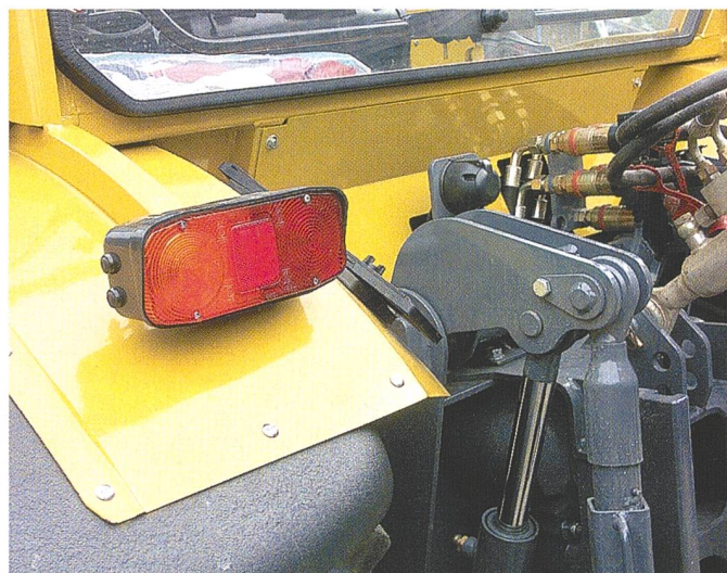
Lange Hubwerkszylinder lassen sich fein dosiert aus- und einfahren und vermindern die Scherkräfte an den Anlenkpunkten. In der Rückleuchte ist die Hydraulikbedienung integriert. Die Zapfwelle lässt sich durch ein patentiertes Heckgetriebe stufenlos zwischen 540 und 1000 Touren variieren.
