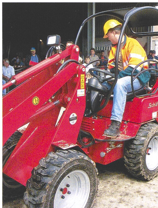
Perfekt ausgerüsteter Knicklenker mit Sicherheitsgurt, Bügeln links und rechts sowie einem Schutzdach.
