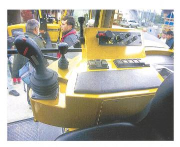
Auf der rechten Konsole: Joystick (mit Taste für die Rückwärtsfahrt), Fahrhebel für die Vorwahl des Geschwindigkeitsbereichs, Handgas und Vorwahl des Fahrmodus sowie sehr übersichtliche Anordnung von Zapfwelle und 3-Punkt-Hydraulik.
